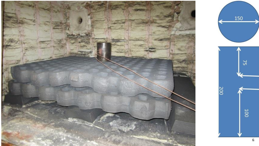
Kuva 15. Ensimmäisten kokeiden koejärjestelyt ja -aihion mitat ja kahden anturin paikat
