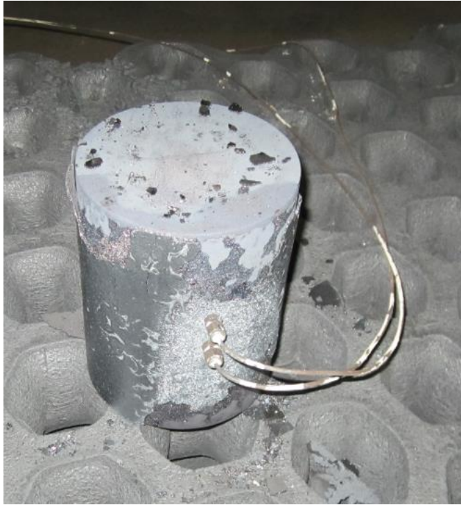
Kuva 19. S235 -valmistettu koekappale ja K-tyypin antureiden paikat
