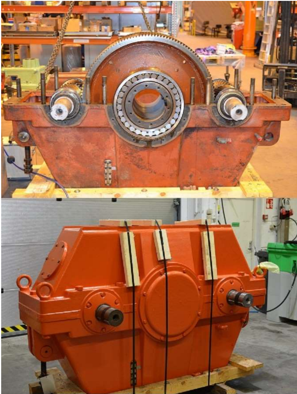
Kuva 3 Huoltovaihte yllä purkuvaiheessa ja alla valmiina asiakkaalle toimitettavaksi (Kuva: Otto Kurjanen 2013)
