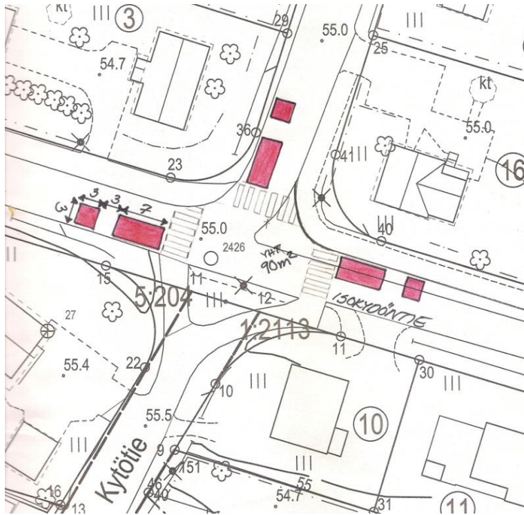
Kuva 23. Pinnoitteen sijoittelu Isokydöntie-Kytötien risteyksessä
