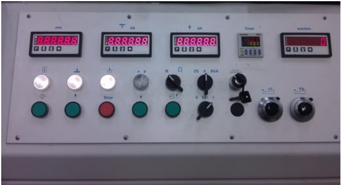
Kuva 7. Erichsen 145–60 muovauskoneen ohjaustaulu
