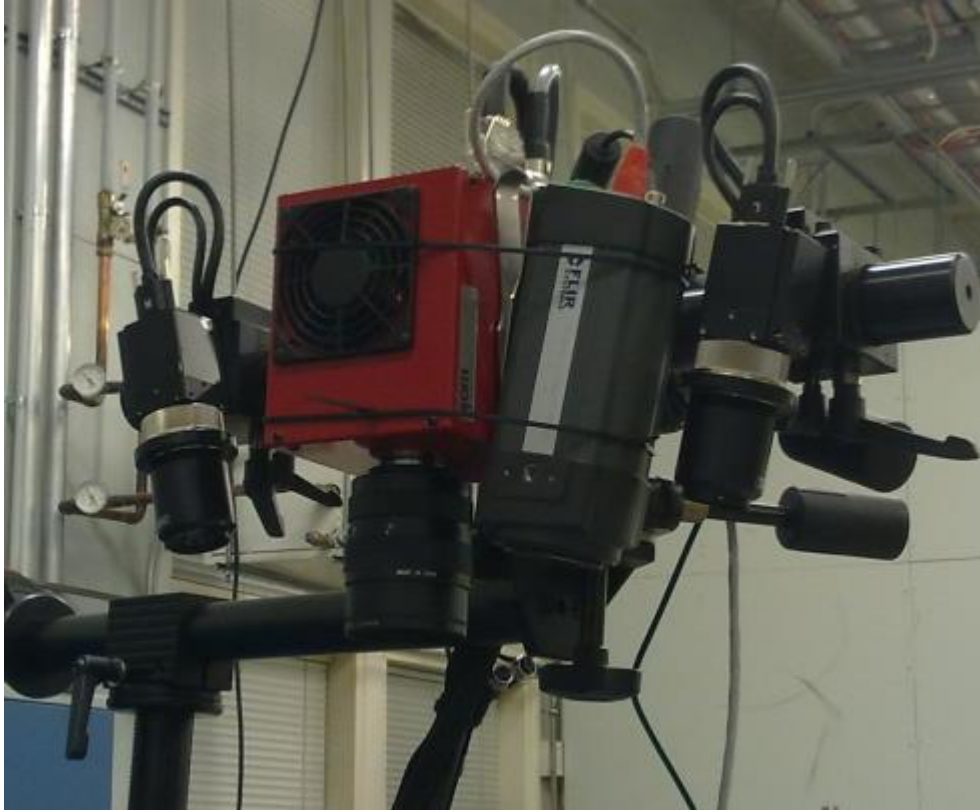
Kuva 8. Lämpökameran kiinnitys Aramis- kamerajärjestelmään.
