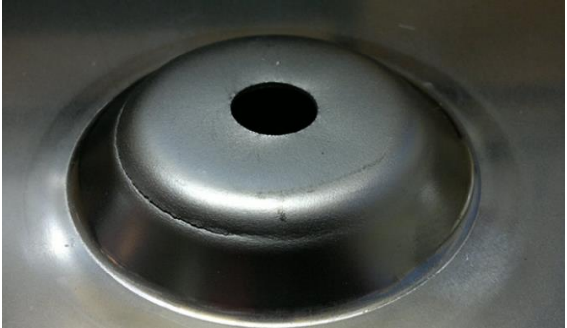
Kuva 18. KWI- reiänlaajennuskokeen murtuma materiaalille EN 1.4521
