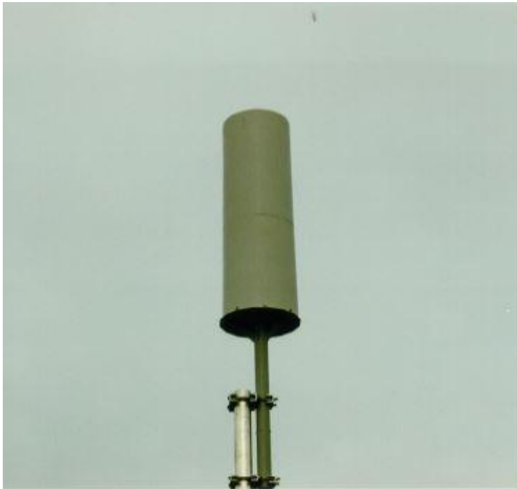
Kuva 9 Aerial D100-1000 Biconical Antenna. Käytettiin tässä työssä tukiaseman antennina.
