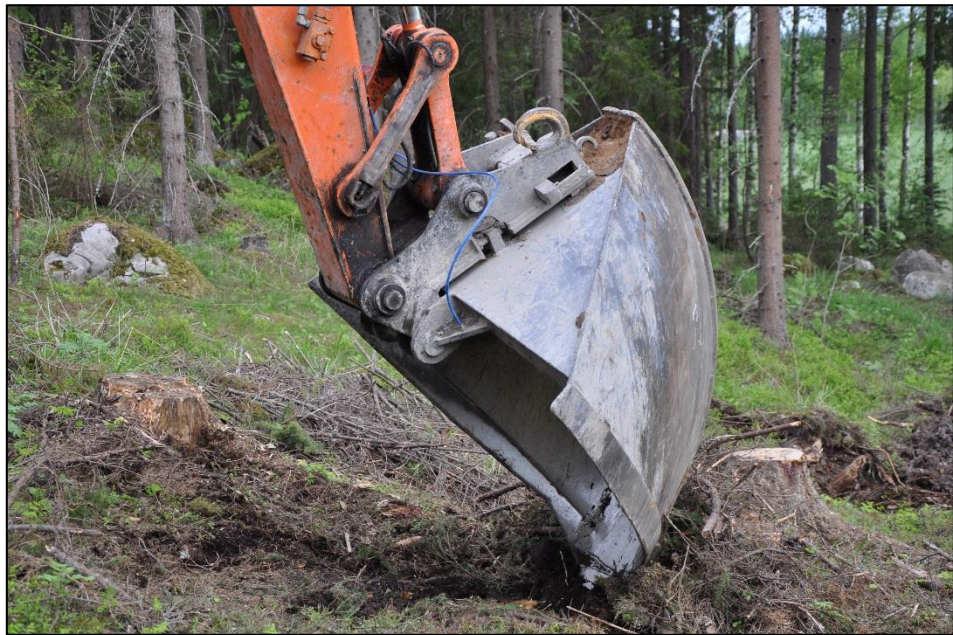
Kuva 4. Siemenrä ammutaan kylvösuuttimista laikkuun paineilman avulla.
