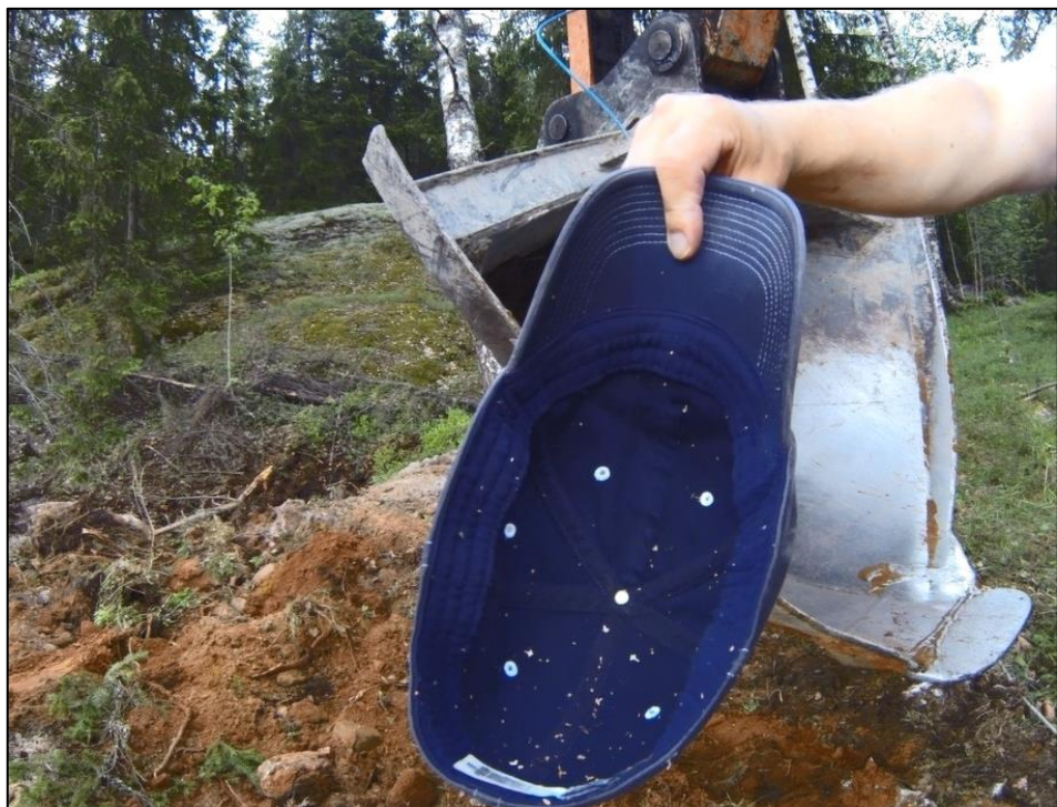
Kuva 30. Kylvösuuttimista lakkiin ammuttu koivun siemenerä. Kuvankaappaus tutkimusvideosta.
