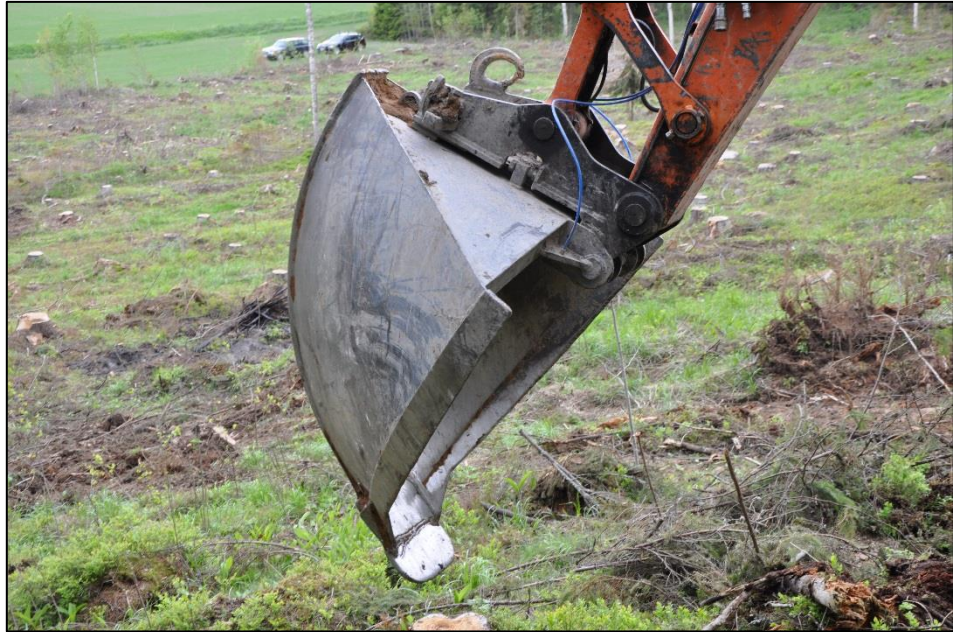
Kuva 29. Kauhan ja kylvösuuttimen asento, kun siemenerä ammuttiin kylvölaikkuun.
