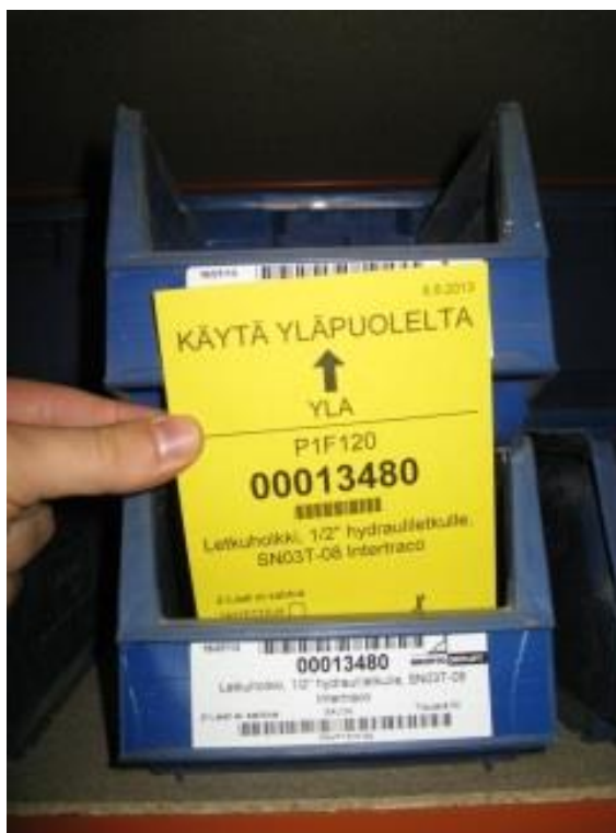
Kuva 10. Kaksi laatikkoa jotka on sijoitettu päällekkäin. Brontolla ylemmästä laatikosta käytetään ensin ja alempi toimii varmuusvarastona (passiivivarasto), kun tilattava erä saapuu, tyhjä laatikko täytetään ja siirretään alimmaiseksi näin varmuusvarastossa säilyy oikea tavaramäärä.
