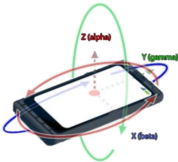
KUVA 2. Laitteen eri akselit ja kallistukset havainnollistettuna (Orientation and motion... 2013)
