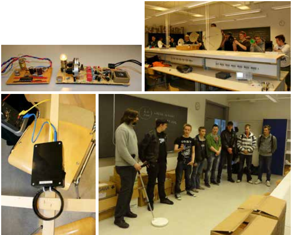
KUVA 1 Elektroniiikan projektituotteita: ääniohjattavia valoja (vuonna 2007–08), salakuuntelulaitteita (2009–10), magneettikentän mittari (2010–11) ja metallinilmaisimia (2011–12).
