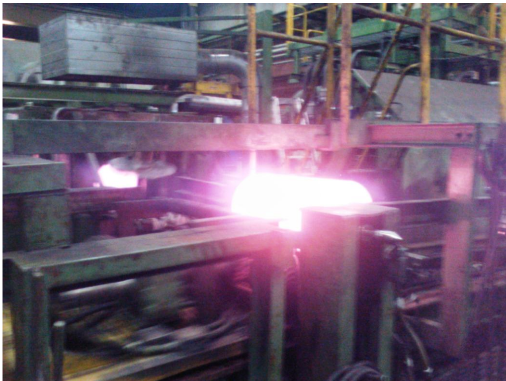
Kuva 8. Loppulämpötilaan kuumennettu kupariaihio siirretään puristimelle. (Jari Kuusela)
