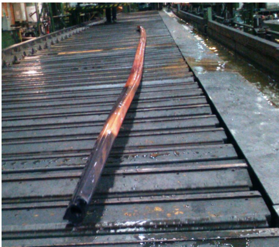
Kuva 11. Vetämön 2500t puristimelta pursotettu D-mallinen lisäkeprofiili. (Jari Kuusela)
