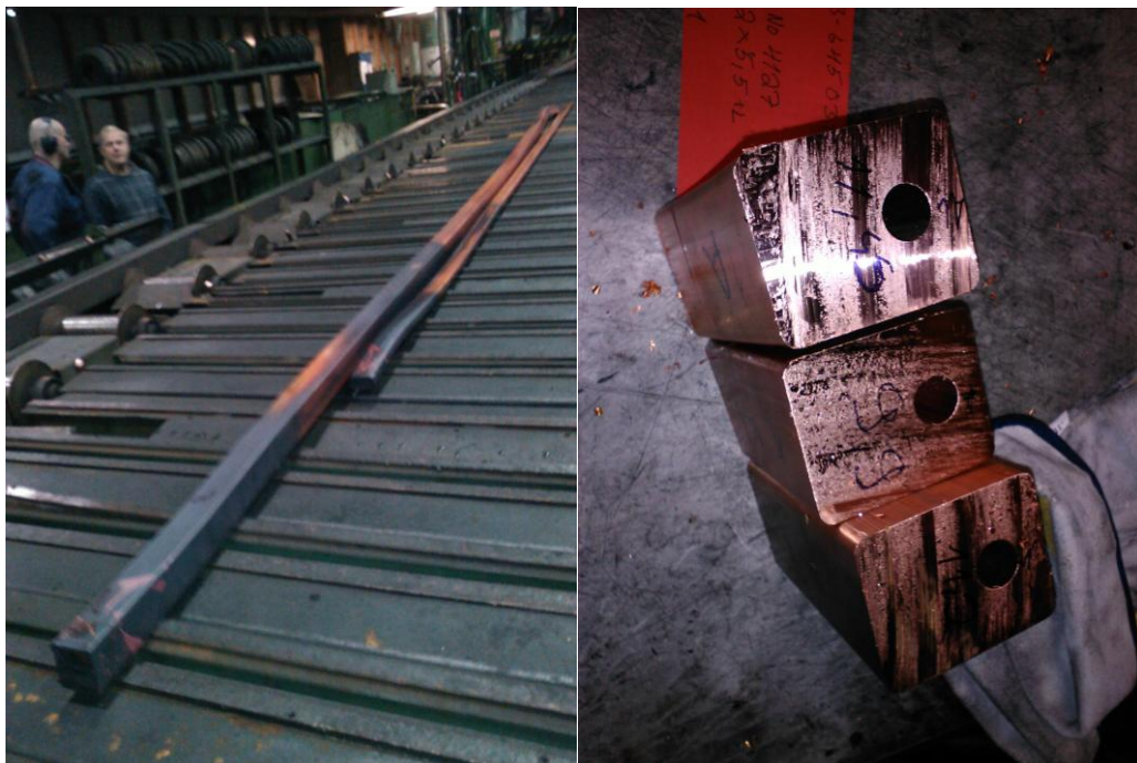
Kuva 26. Vasemmalla koepursotuksen pursote, jossa lisäksi poisto toteutettu uudelleen suunnitellulla matriisilla. Kuvassa näkyy aihion rinnalla lisäksi pursote erillisenä tankona. Oikealla näytepalat pursotteen alusta, keskeltä ja lopusta. (Jari Kuusela)
