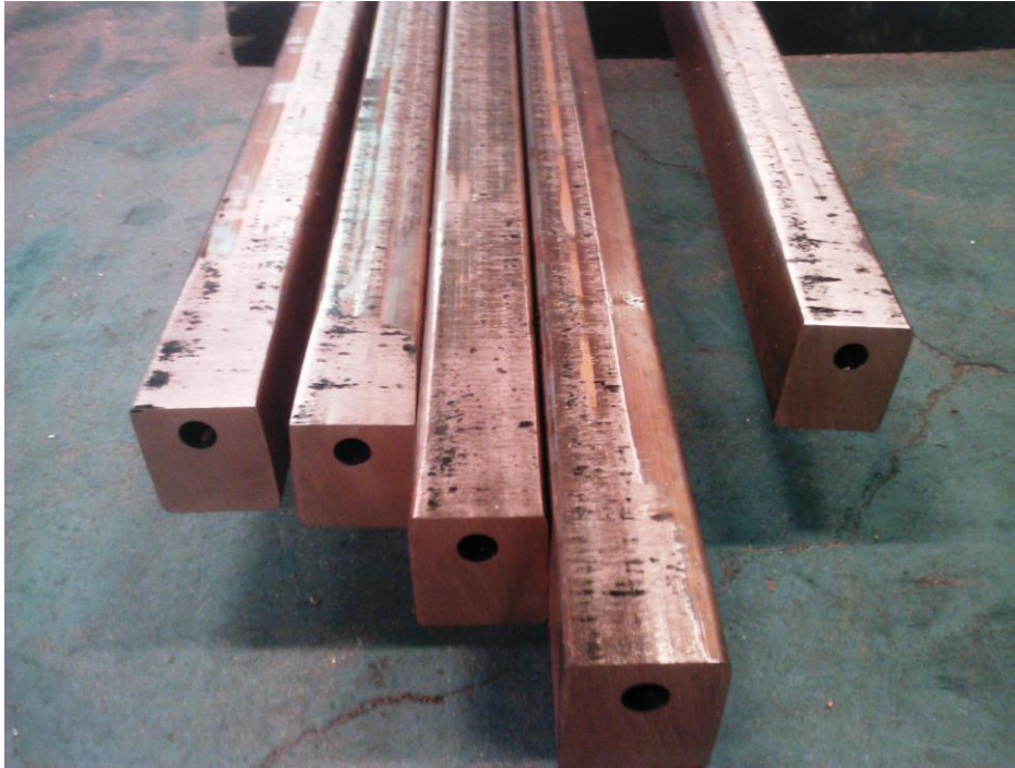
Kuva 13. Profiiliputken pinta lisäkkeen sahauksen jälkeen. (Jari Kuusela)
