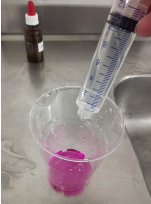
Kuva 12. Pesuainepitoisuuden määrittäminen titrausmenetelmällä.
