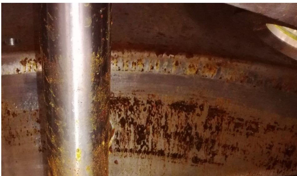
Kuva 5. Prosessisäiliön pintaan palaneita tuotejäämiä.
