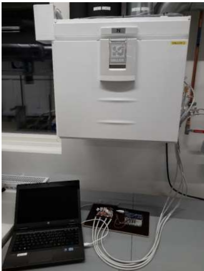
Iltanvaihtokoneen lämmönvaihtimen hyötysuhteen mittaussjärjestely
