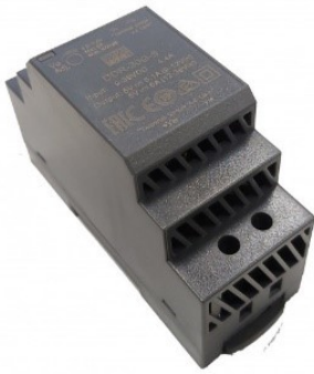
KUVA 12. Step-down DC/DC -muunnin. (Partco 2021b)
