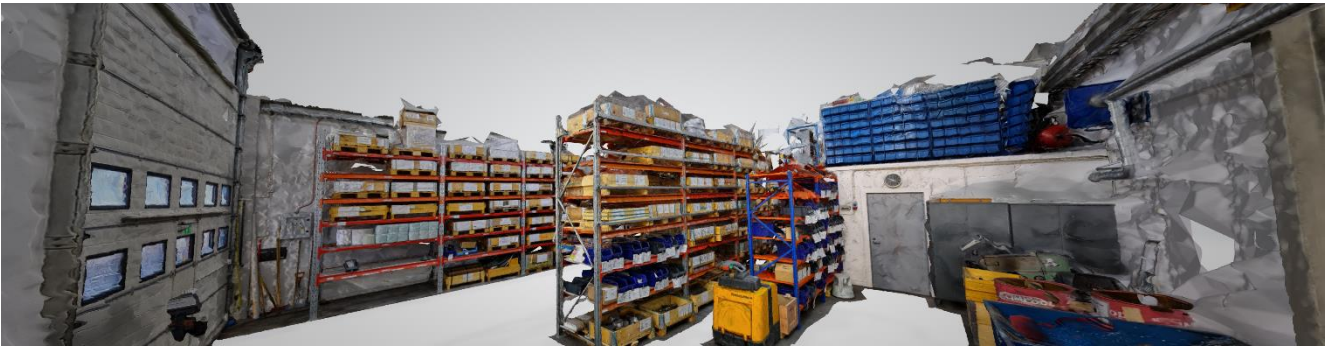
KUVA 8. Ab Ferromek Oy:n optimoimaton fotogrammetriamalli. Verteksejä on noin 20 miljoonaa. Malli on todella tarkka, mutta se ei sovellu tällaisenaan pelimoottorin käyttöön.
