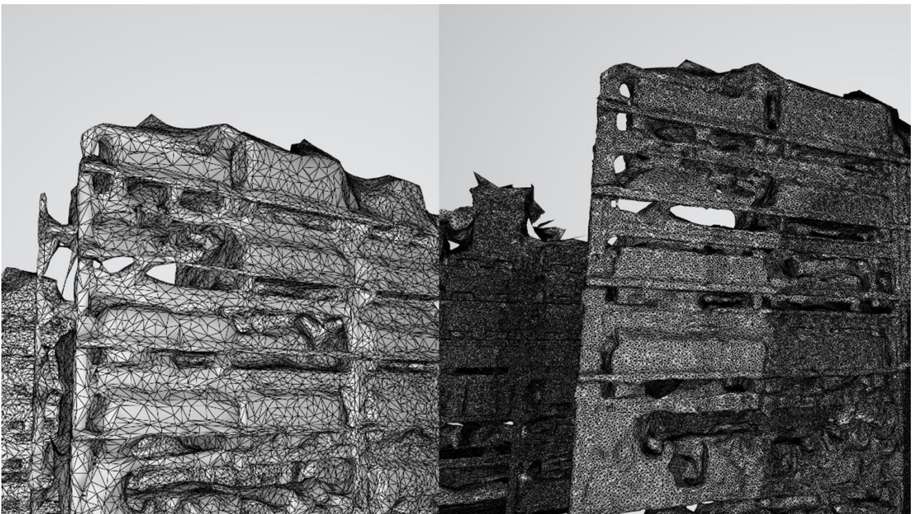
KUVA 12. Ero verteksien määrässä optimoidu (vas.) ja optimoimattoman mallin välillä.
