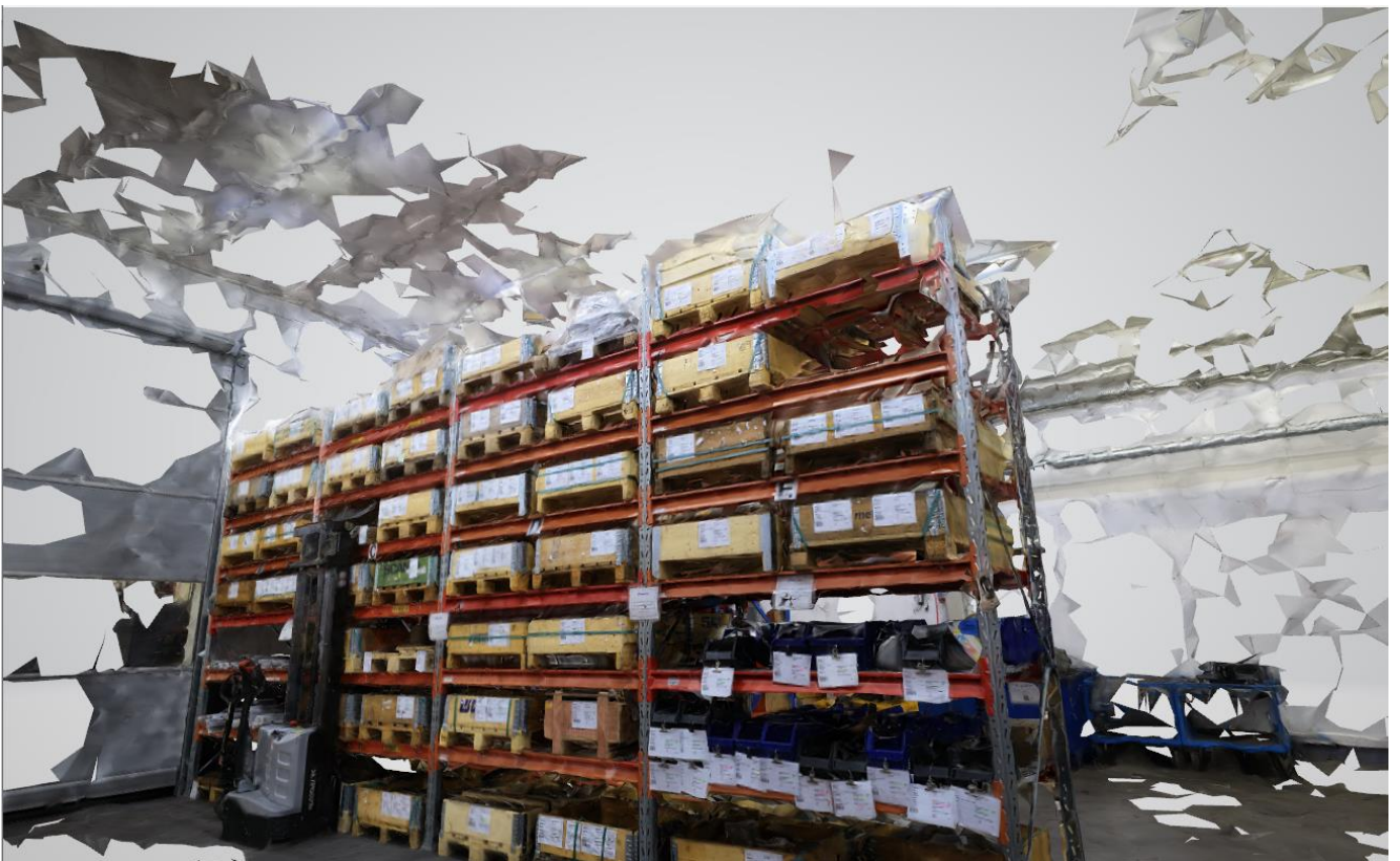
KUVA 9. Koska dataa ei ole saatavilla, 3DF Zephyr ei pysty mallintamaan osia katosta ja lattiasta. Nämä osat poistettiin mallista optimoinnin yhteydessä ja rakennettiin uudelleen Unityssa.
