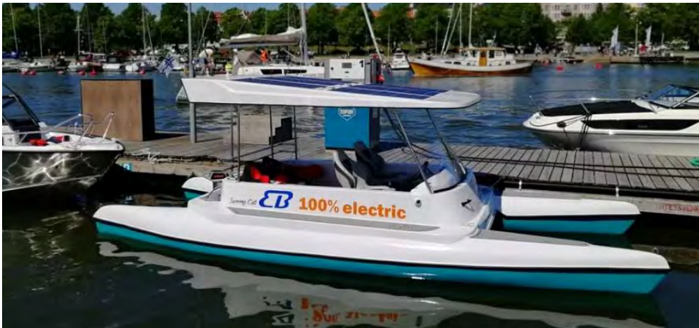
E-Boatin Sunnycat on katamaraanirunkoinen vene. Avokatolla aurinkopaneelit parantamassa akkulatausta. Katamaraanin ponttonit ovat ilmatäytteiset.
