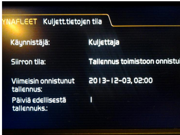
KUVA 7. Ilmoitus kuljettajakortin tietojen etätallennuksen onnistumisesta. (Volvo FH4 SID-High ajoneuvon infojärjestelmän Dynafleet valikko.)
