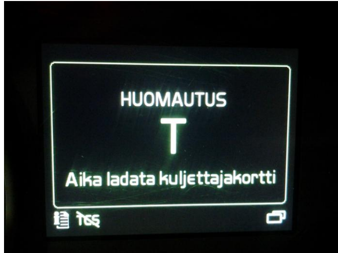
KUVA 5. Ilmoitus kuljettajakortin tietojen tallennustarpeesta. (Volvo FH4 SID-High ajoneuvon infojärjestelmän Dynafleet valikko.)
