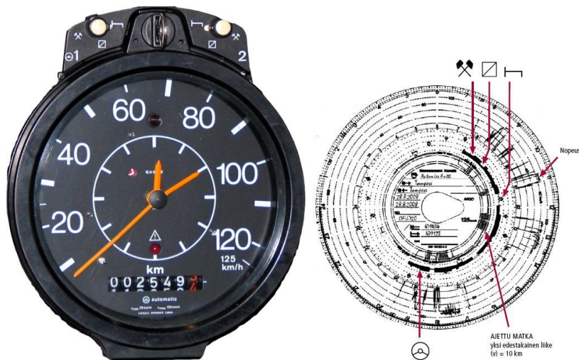
KUVA 1. Analoginen ajopiirturi (Piirla Oy) ja siinä käytettävä piirturikiekkko (Työsuojeluhallinto 2013b).
