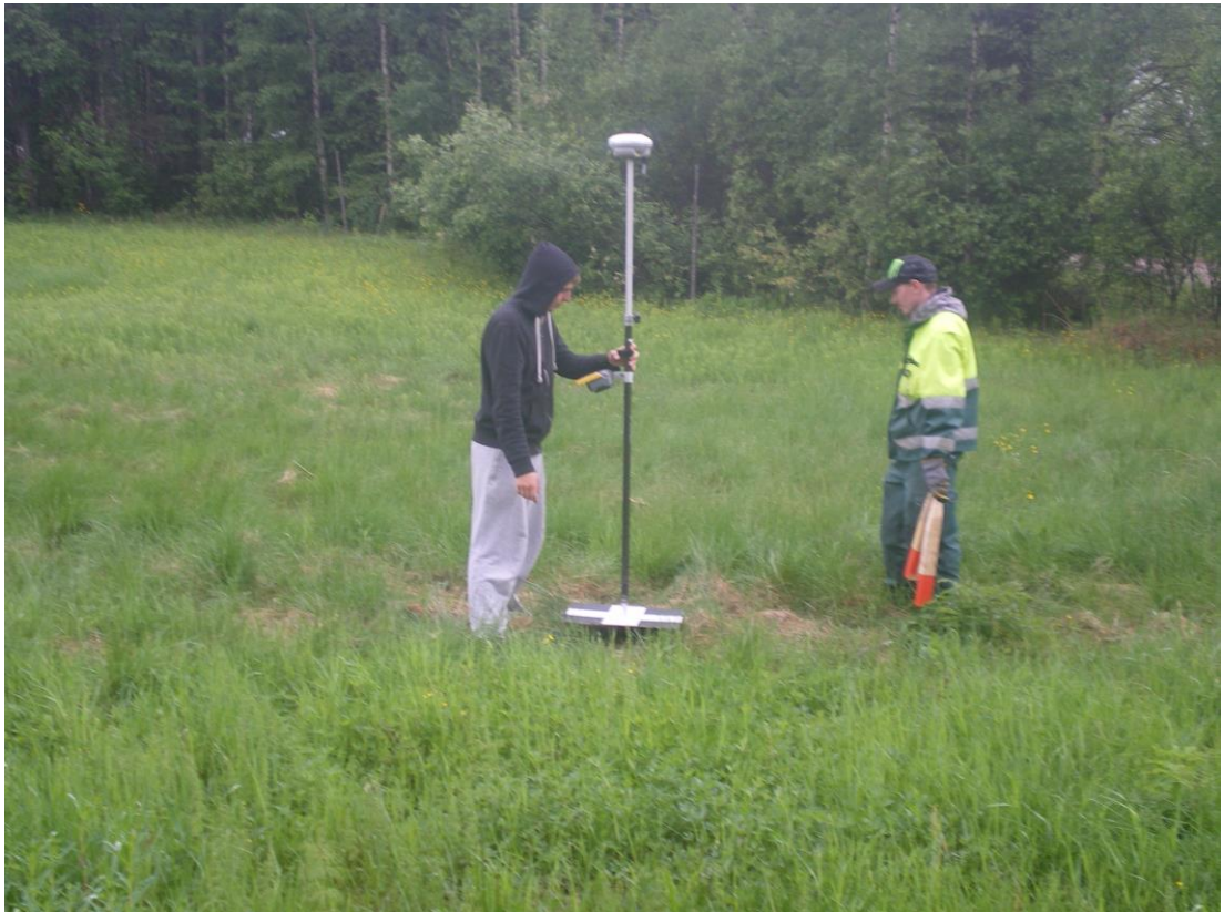
Kuvio 4. Signaalien mittaus Trimble R8 GPS- laitteella.
