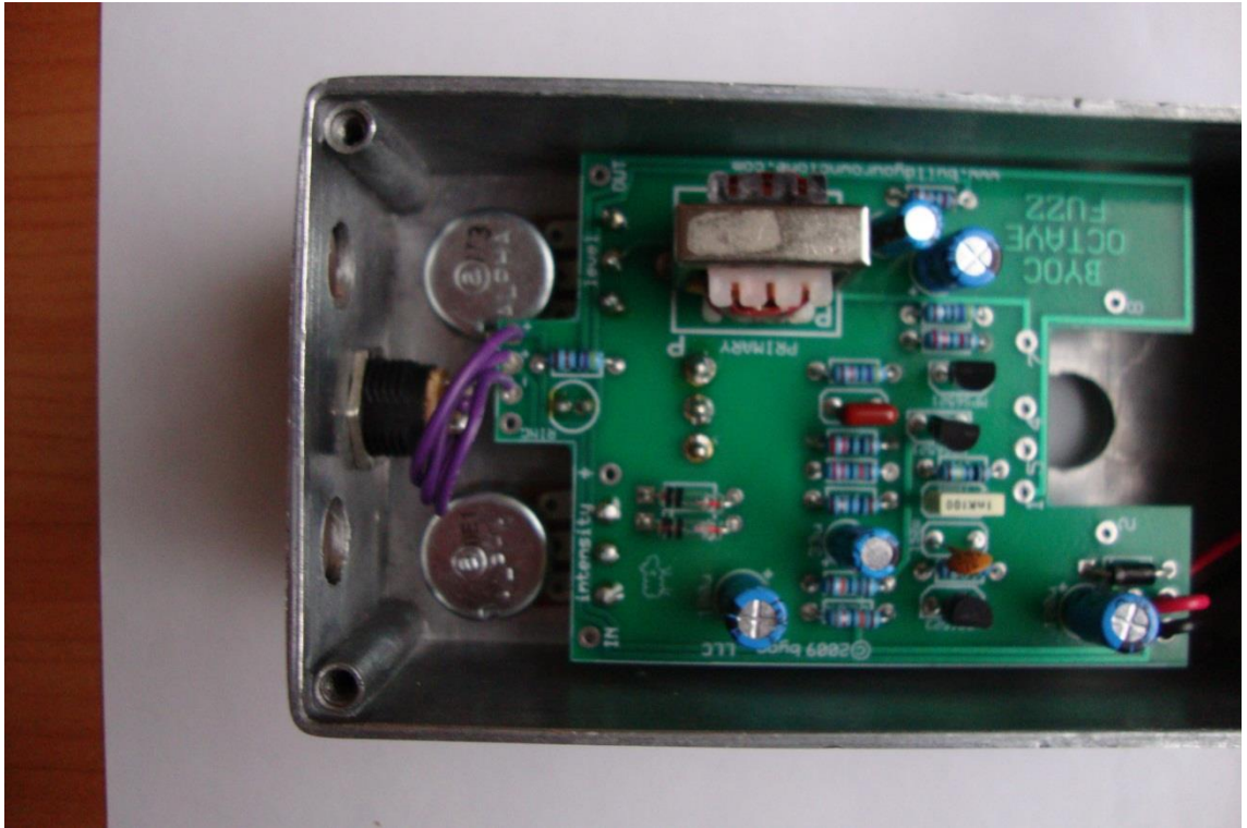
Kuva 15. Ledin, potentiometrien ja vipukytimen kiinnitys.
