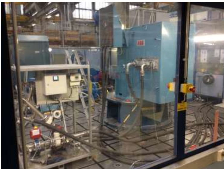
Kuva 5. Testattava induktiomootori testikentällä.
