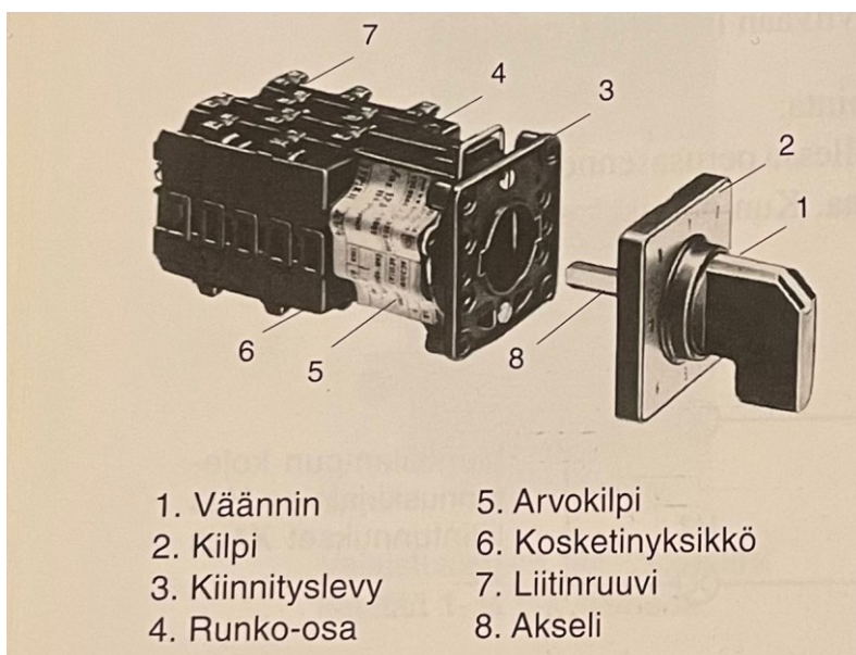
Kuva 9. Nokkakytkimen rakenne. [5, s. 90.]
