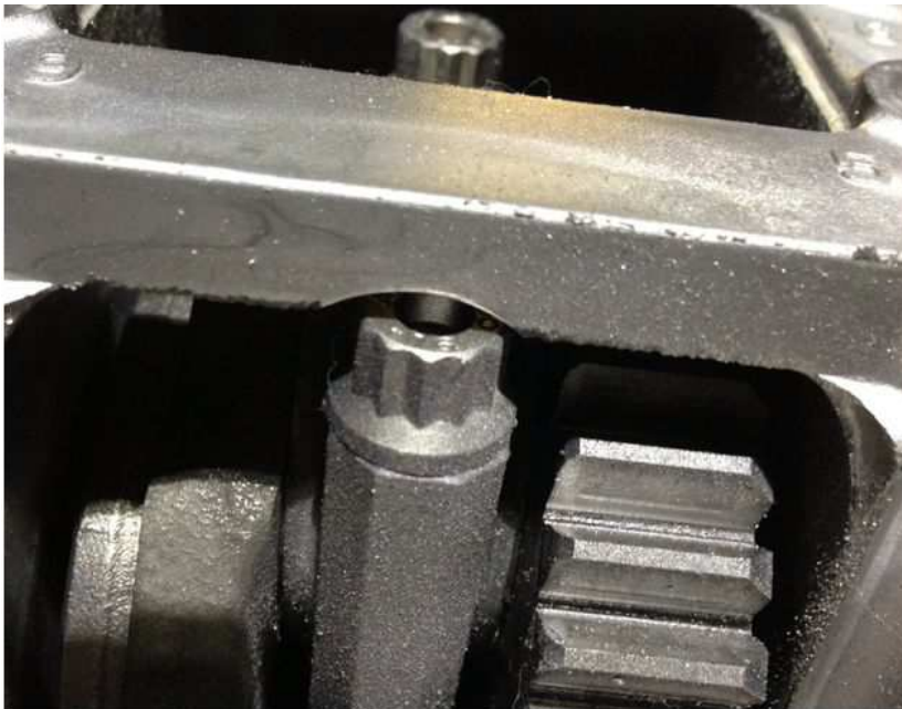
KUVA 8. Kolo moottorin rungossa kiertokangen pultin kohdalla
