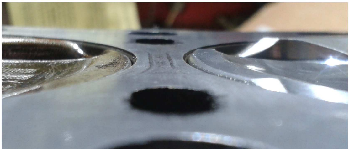
KUVA 7. Alkuperäinen ja vahvempi mäntä sylinteriryhmässä yläkuolokohdassa
