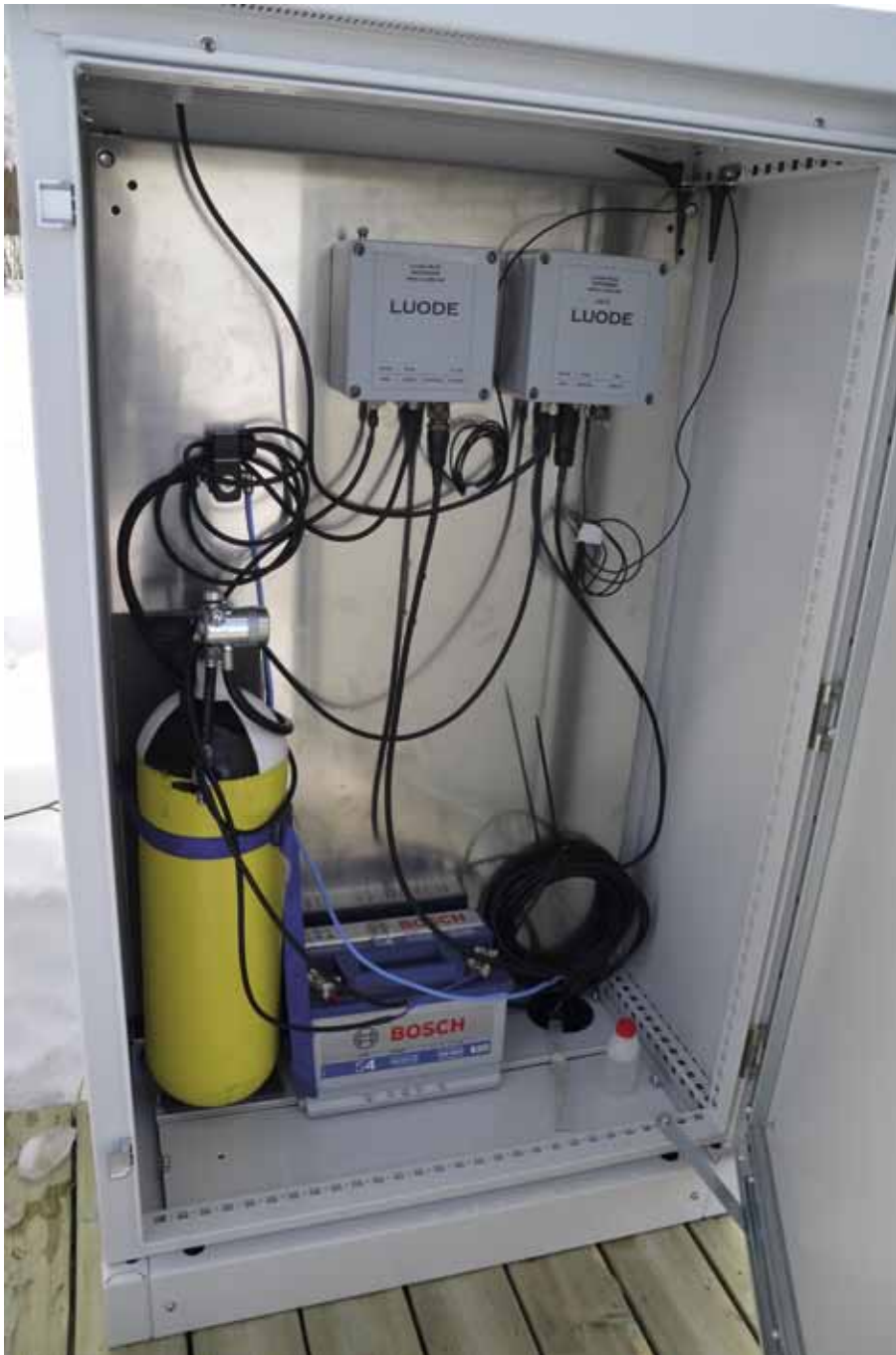
KUVA 3. Mittausaseman suojakaappi, jossa on akku, kaksi dataloggeria, paineilmapullo ja aurinkopaneelijärjestelmä. (Kuva: Samuli Lahtela, JAMK.)
