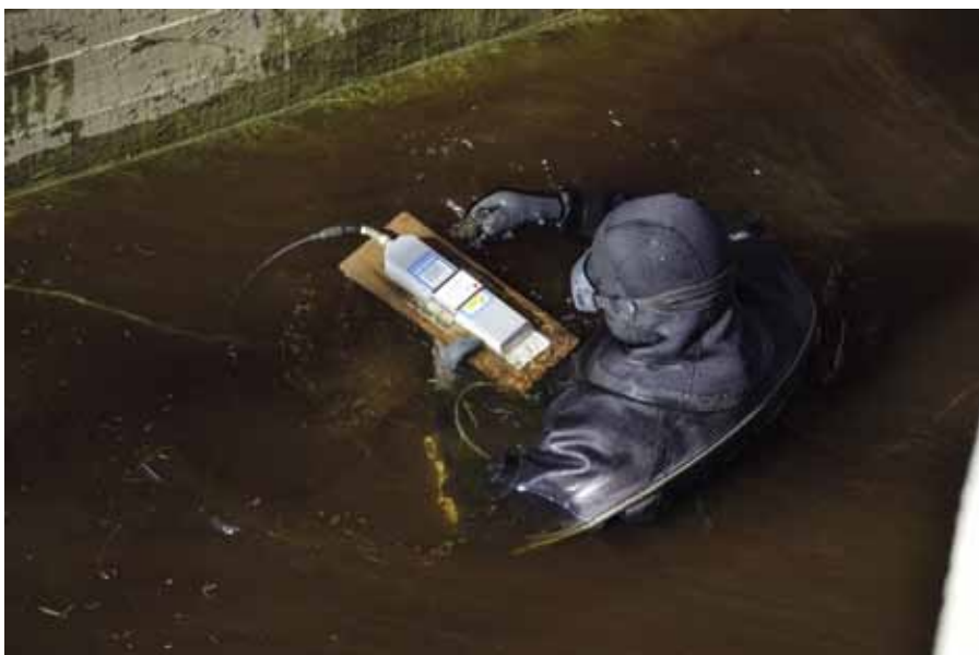
KUVA 5. Akustinen virtaamanmittauslaite puhdistettavana. (Kuva: Samuli Lahtela, JAMK.)
