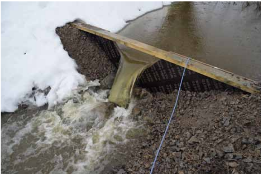
KUVA 4. Virtaaman mittaukseen käytetty kolmiomittapato. (Kuva: Samuli Lahtela, JAMK.)
