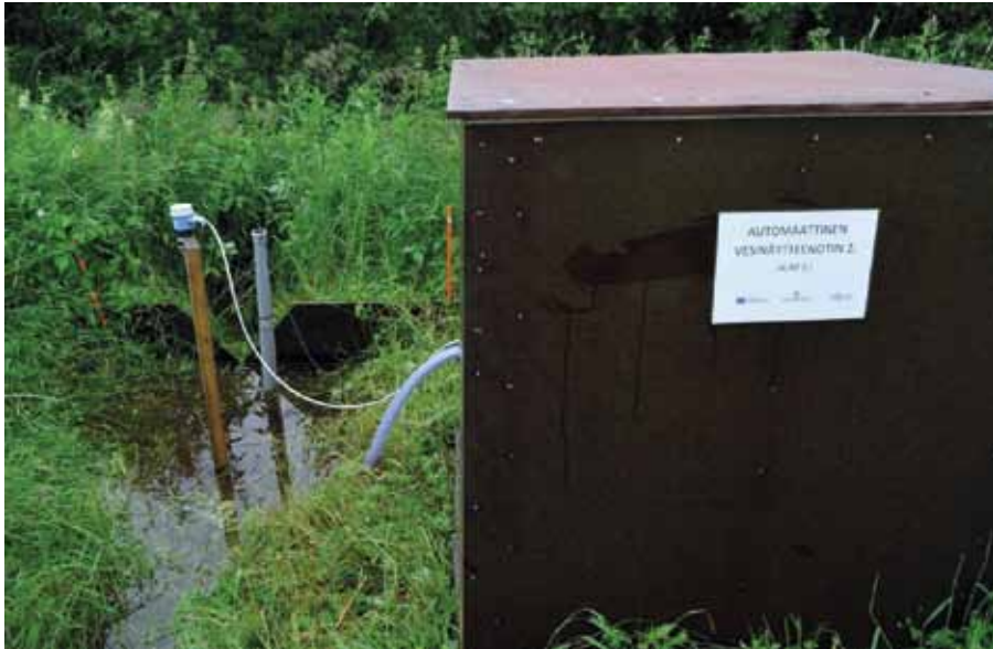
KUVA 7. Automaattinen vesinäytteenottojärjestelmä. Koelohkoilta valuva vesi valuu keruuojien kautta mittauskuoppiin, jossa pintakytkimet havaitsevat veden ja vesinäytteenottimet ottavat vesinäytteen. Vesinäytteenottimet on sijoitettu lämpöeristetyssä mittauslaatikon sisälle. (Kuva: Samuli Lahtela, JAMK.)
