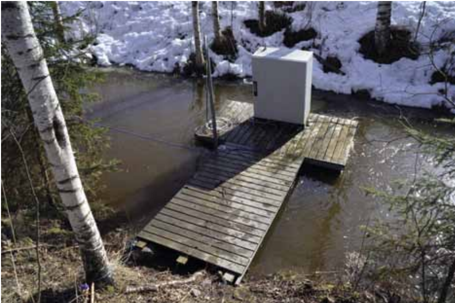
KUVA 2. Satusuonpuron toisella mittausasemalla mittauslaitteet kiinnitettiin pontoneilla varustettuun laituriin. (Kuva: Samuli Lahtela, JAMK.)
