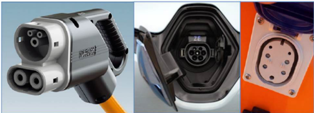
Kuva 26: Combo 2 latauspistoke vasemmalla, Chameleon pistokeliitin autossa ja pistorasia latausasemassa.
