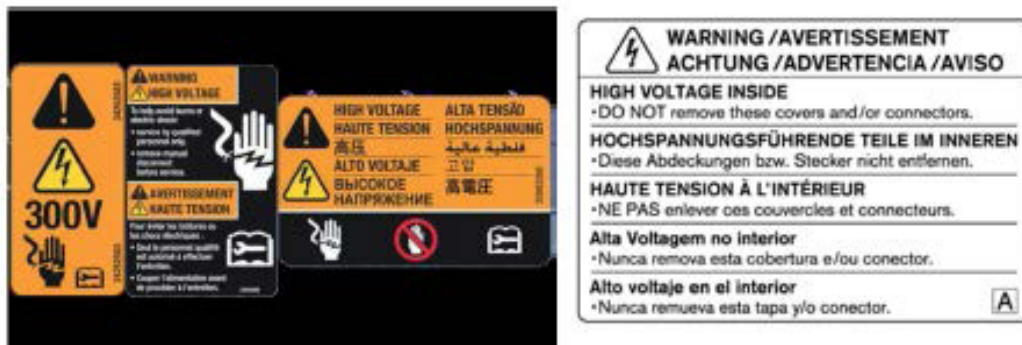
Kuva 28: Sähköauton akusta varoitettava kilpi
