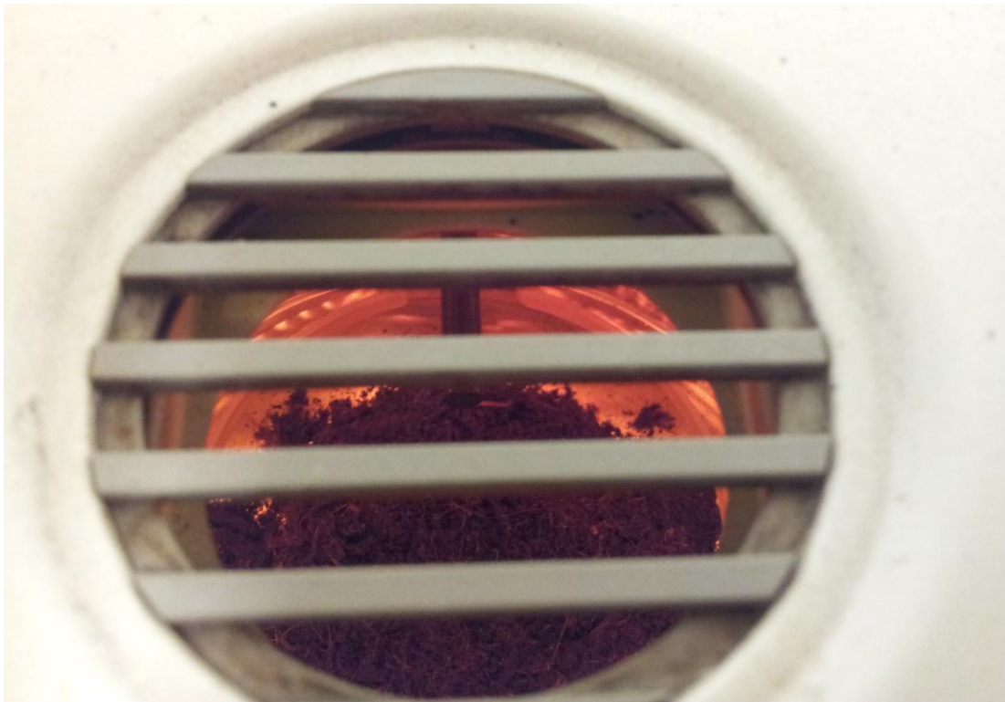
Kuva 10. Näytteen kuivaus pika-analysaattorilla (Koskela 2013).
