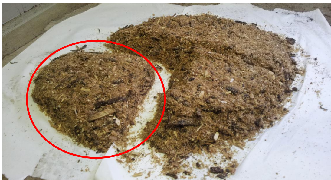
Kuva 17. Näytekakun jako yhtäsuuriin osiin (Koskela 2013).
