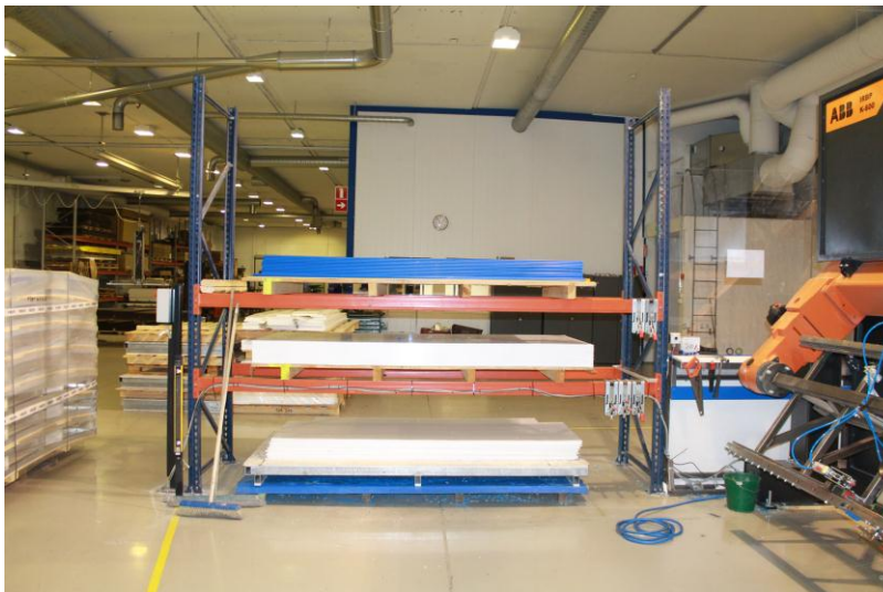
KUVIO 7. Kokoonpanorobottisolun suojaseinä yhdistettynä materiaaliavarastona (Raita Sport 2013)
