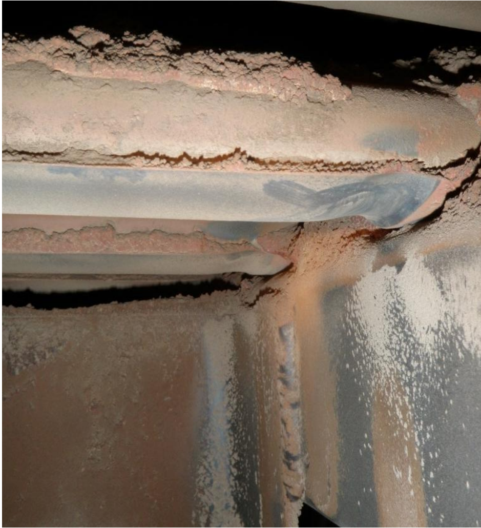
Kuva 25. Nuohoimen kannakkeen kanavoiman nuohoushöyryn aiheuttamaa kulumista ekossa
