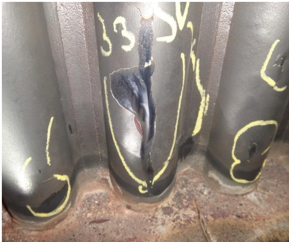
Kuva 20. CFB-kattilan eroosiota muurausrajan yläpuolella pinnoitteen puhjettua
