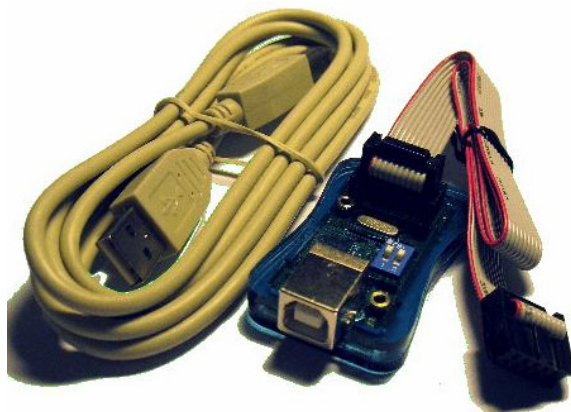
KUVIO 7. Atmel ISP USB-obdointilaite (Obd Automotive Oy 2009.)
