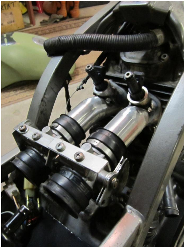
Kuvio 19. Imusarja ja läppärungot kiinnitettynä sylinterikanteen.
