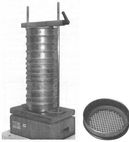
Kuva 12. Seulasarja asennettuna täryttimeen sekä yksittäinen 8 mm seula. (Jääskeläinen 2011, 17)
