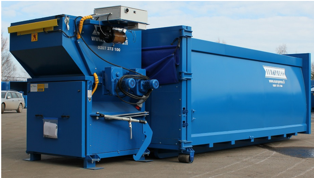
Kuva 5. Europress Group Oy edustaa saksalaisen H&G:n valmistamia ruuvipuristimia. Ruuvipuristin on pääosin tarkoitettu käsittelemään suuria ja paksuja pahveja. Toisin kuin muissa puristinmalleissa, tässä laitteessa on suuri ja voimakas ruuvi, joka murskaa pahvit ja työntää konttiin. Ruuvipuristimessa kontti ja puristin irtoavat toisistaan kuten Duo-puristimessa. [4.]
