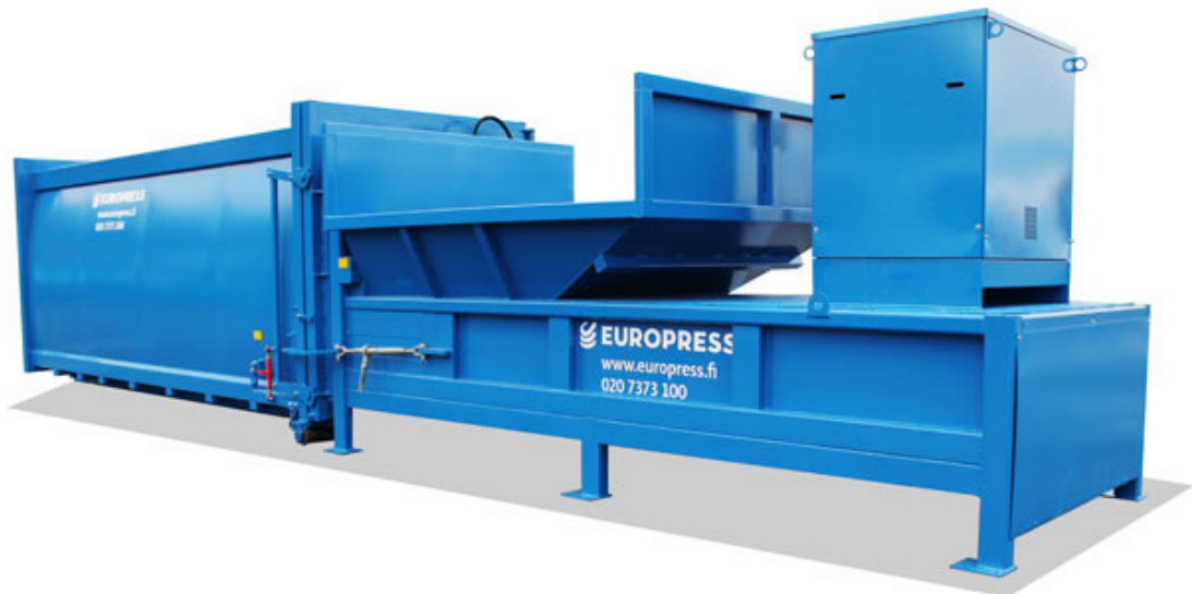
Kuva 4. EPC-puristimet ovat esipuristuslevyllä varustettuja puristimia erittäin suurten jätemäärien käsittelyyn. Esipuristettu jäte on jo konttiin laitettaessa tiiviissä muodossa, jolloin siihen ei jää ilmataskuja. Tämän avulla kontin kapasiteetti saadaan hyödynnettyä parhaalla mahdollisella tavalla. [4.]
