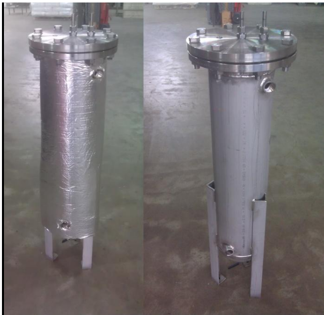
Kuva 9. Lämmönvaihdin kasattuna ja eristettynä
