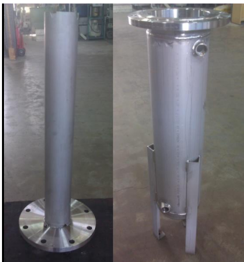
Kuva 6. Säiliö ja keskiputki hitsattuna sekä peitattuna
