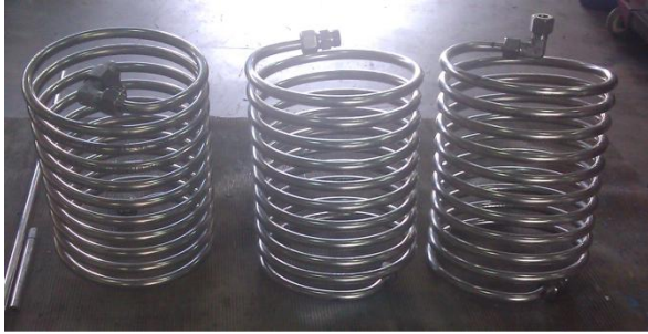
Kuva 7. Kierukan helmiliittimet kiristettynä
