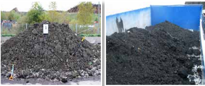
KUVAT 4. Määdätyssäännöksen varastointi laitosalueella on nykykäytäntö monilla biokaasulaitoksilla. Hankkeessa selvitetään kasavarastoinnin aikana tapahtuvia laatumuutoksia ja siitä aiheutuvia valumia. Kuva vasemmalla: Terhi Björklund, kuva oikealla: Anni Pihkamäki.
