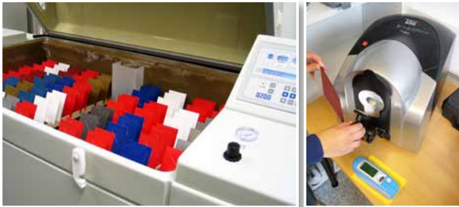
KUVAT 2 & 3. Korroosiokaappiin (vas.) mahtuu monenmuotoisia ja -kokoisia näytteitä. Värimittarilla (oik.) seurataan materiaalin vanhenemista.
