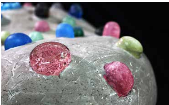
KUVA 3. Biohartsia ja lasimurskaa sisältävä betonikappale. Kuva: Marjo Kilgast.
