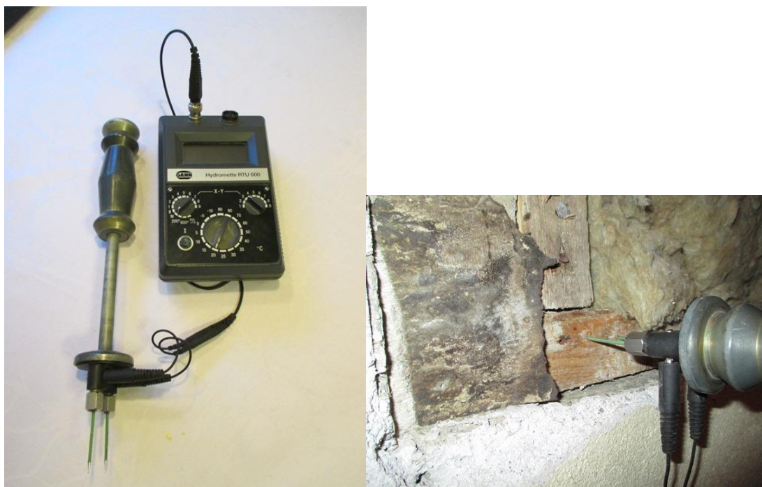
Bild 8. Mätning av fukt i mjuka material. (Mätare: GANN Hydromette RTU 600 med en GANN M18 givare.) (Bild Jonas Lindqvist)
