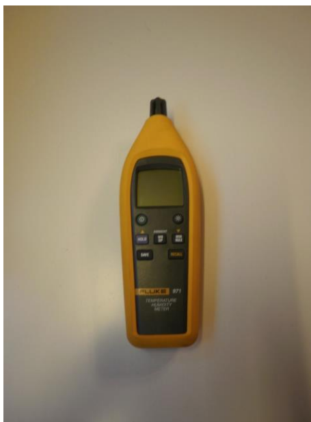
Bild 12. Temperatur- och luftfuktighetsmätaren som användes vid mätningarna (Fluke 971). (Bild Jonas Lindqvist)
