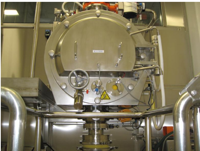
Kuva 12. Kuva jälkikäsittelyn kuivaimesta
