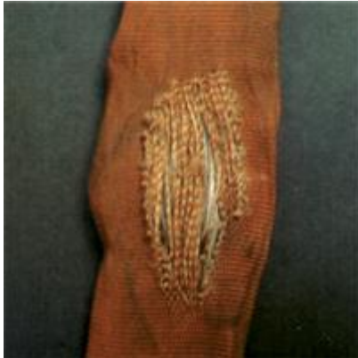
Kuva 18 Päälysteraksin suojakangas on vaurioitunut (Certex Finland Oy:n www-sivut, hakupäivä 17.3.2014).
