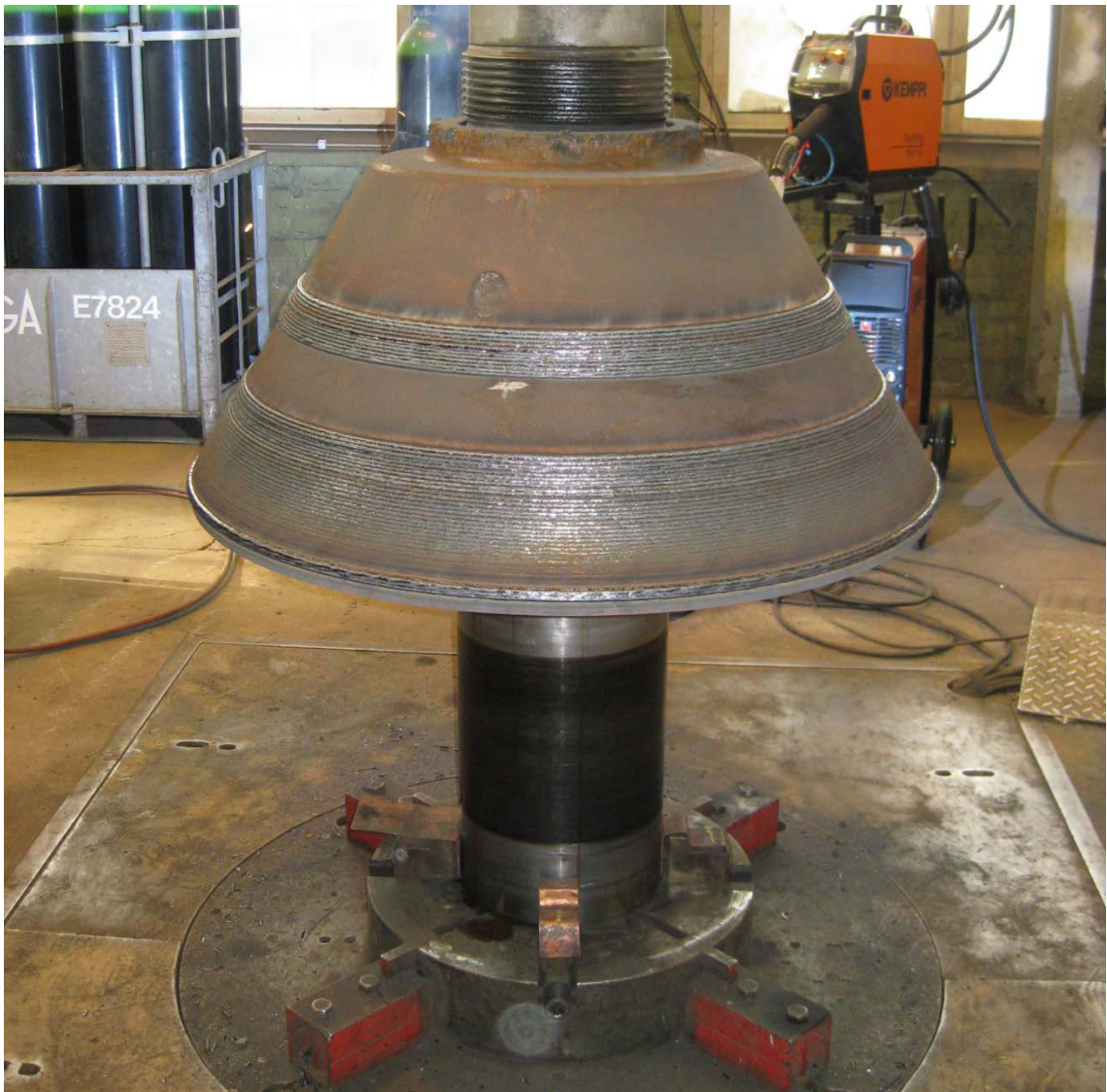
Kuva 2. Robottihitsauspaikalla täytehitsattu karamurskaimen kara-akselin tukikartio
