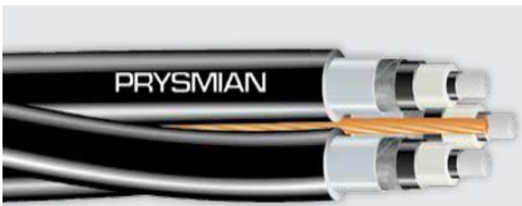
Kuva 2. 20 kV keskijännitekaapeli AHXAMK-W. Kuparinen maaköysi, alumiini johdin, johdinsuoja, PEX-eristys, hohtosuoja, paisuntakerros, kosketussuoja ja vaippa ( Prysmian Group:n www-sivut 2013, hakupäivä 27.12.2013)
