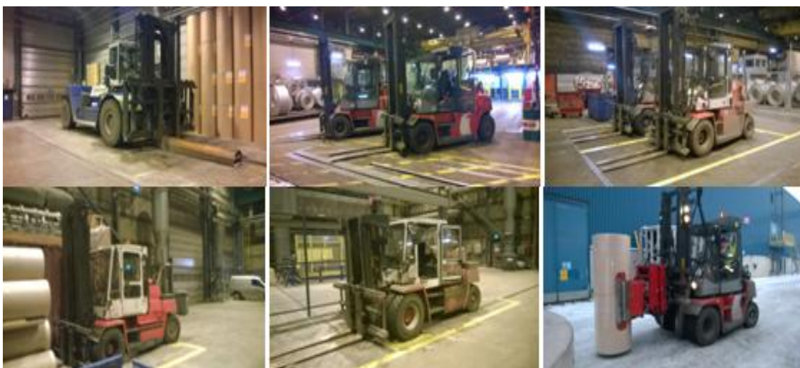
Kuva 2. Kyva 1 haarukkatrukit 8 kpl nostotehoiltaan 5t - 42t
