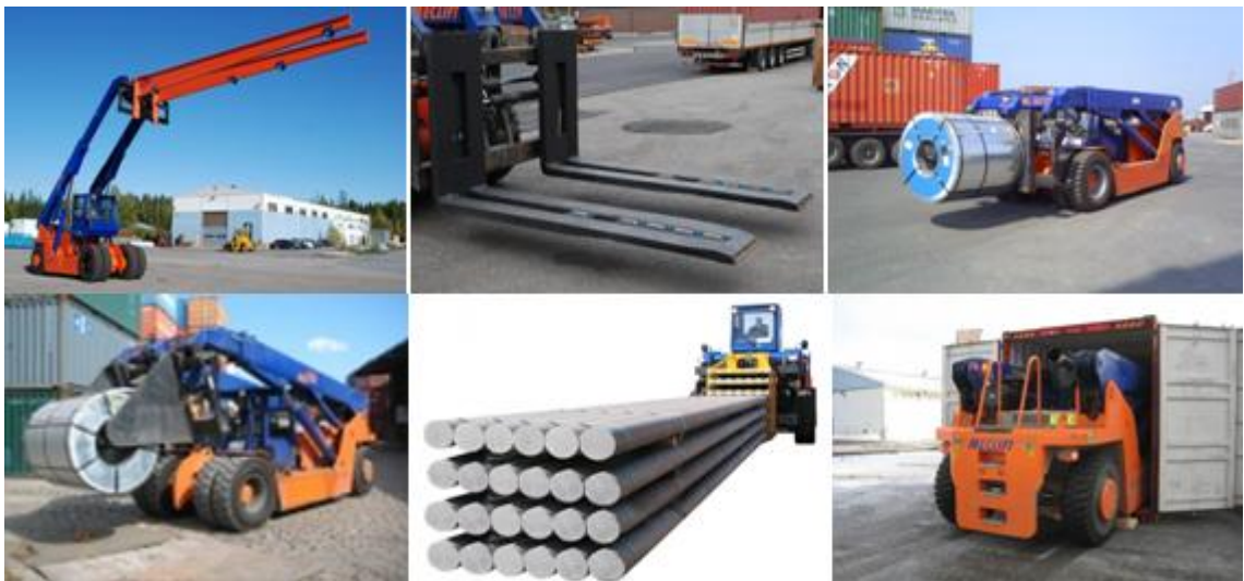
Kuva 6. Erilaisia nostoapuvälineitä (Meclift Oy, hakupäivä 12.3.2014)
