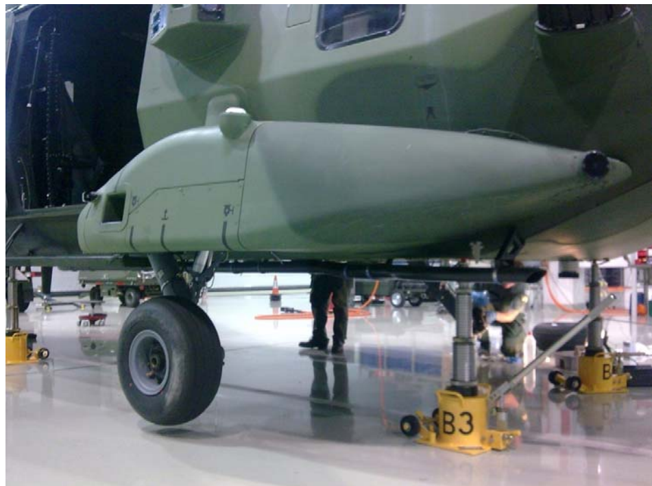
Kuva 11 NH90-helikopteri nostettuna hydraulisilla nostimilla
