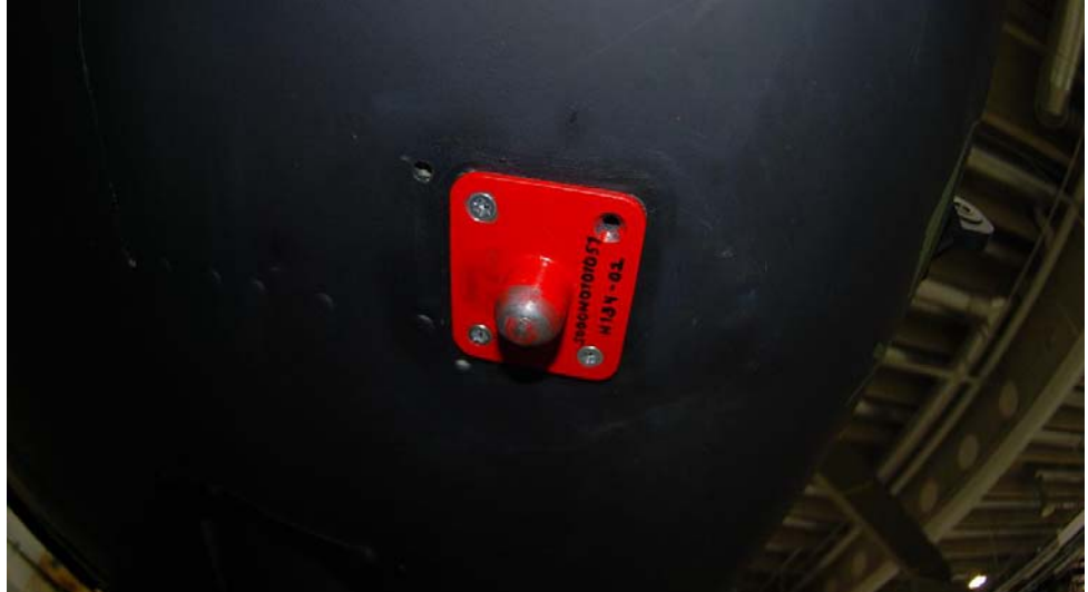
Kuva 14 Nostopala kiinnitettynä helikopterin pohjaan
