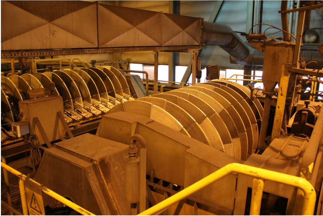
Kuva 3. Suotimet 3240 ja 3250, joista on hyvin nähtävissä suodinkiekkojen levyistä koostuva rakenne.
