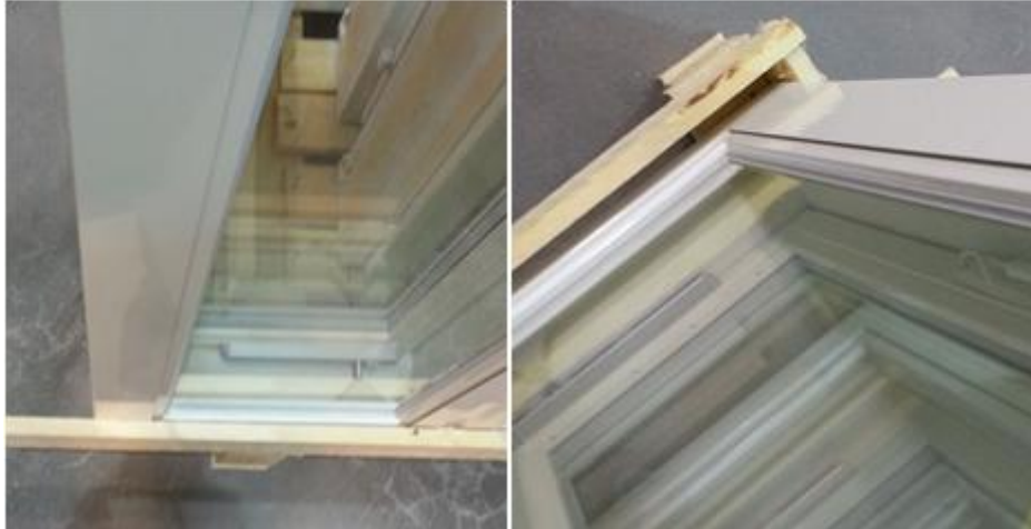
Kuvio 5. Tuotetta suojaava lauta on kiinnitetty virheellisesti kiinni tuotteeseen (vas.) sekä tuotetta suojaava lauta on kiinnitetty oikealla tavalla (oik.)
