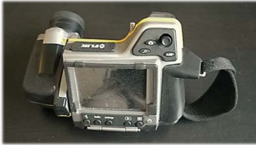
Kuvio 16. Flir B335 -lämpökamera
