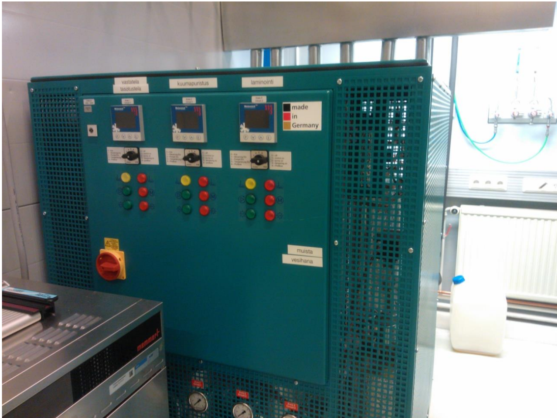
KUVA 9. Maxin öljynlämmönsiirrin koneisto
