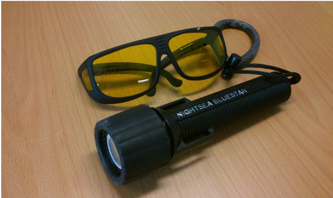
Kuva 7. Taskukokoinen sinistä valoa lähettävä tutkimusvalaisin sekä keltaiset suodatinlasit
