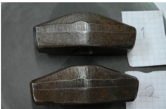
Kuva 20. Magneettijauhetaarkastuksessa käytettävät kappaleet normaalissa huoneen valaistuksessa
