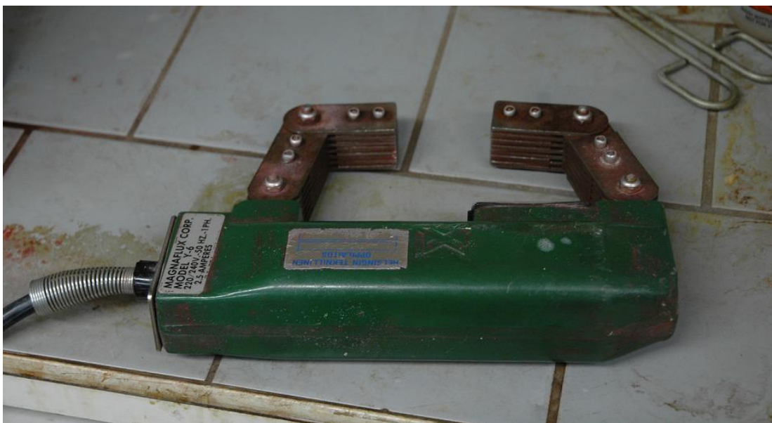
Kuva 23. Käytetty iesmagnetointilaitte Magnaflux corp. Model Y-6
