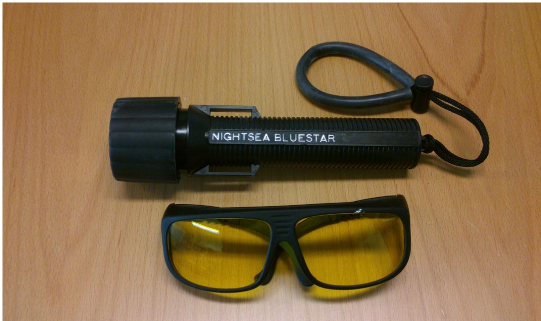
Kuva 10. Sinistä valoa lähettävä tutkimusvalo ja sen yhteydessä käytettävät lasit
