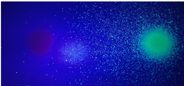
Kuva 15. Tunkeumanesteet valaistuna uv-valolla pimeässä
