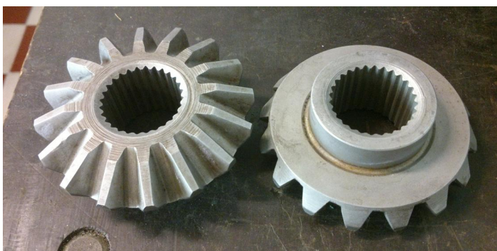
Kuva 21. Tunkeumanestetarkastuksessa käytettävät nuorrutusterästä olevat rattaat
