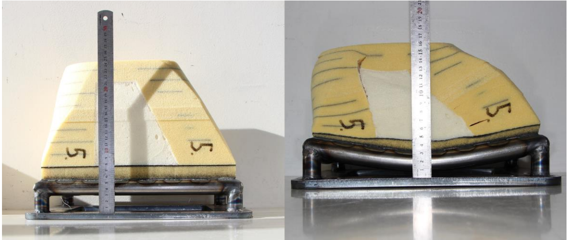
Kuva 11. Ennen ja jälkeen törmäystestin otetut kuvat, joista käy ilmi pysyvät muodonmuutokset törmäysvaimentimen rakenteessa.
