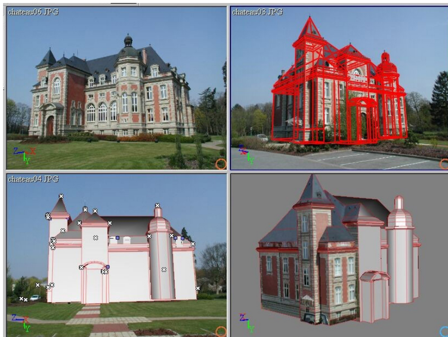
Kuva 14. REALVIZ Image Modeler -ohjelma, jossa 3D-malli on piirretty manuaalisesti valokuvien avulla (Realviz Releases ImageModeler 3.5 for Windows 2003).
