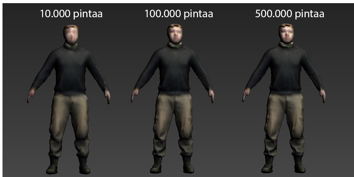
Kuva 19. Skanect-ohjelmalla 3D-skannatun 3D-mallin optimoinnista seuraa tekstuurin huonontuminen, kun 3D-mallin pintojen määrää vähennetään.
