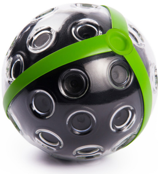
Kuva 32. Panono-360°-panoraamakuvauslaite ja sen käyttömahdollisuuksia (Panoramic ball camera, product features 2013).
