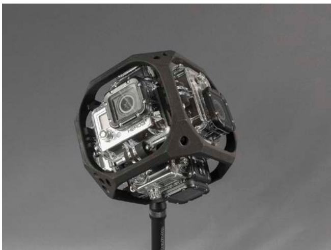
Kuva 23. GoPro Hero 3 kameroista rakennettu monikamerajärjestelmä 360°-panoraamakuvaukseen (F360 Explorer 2014).
