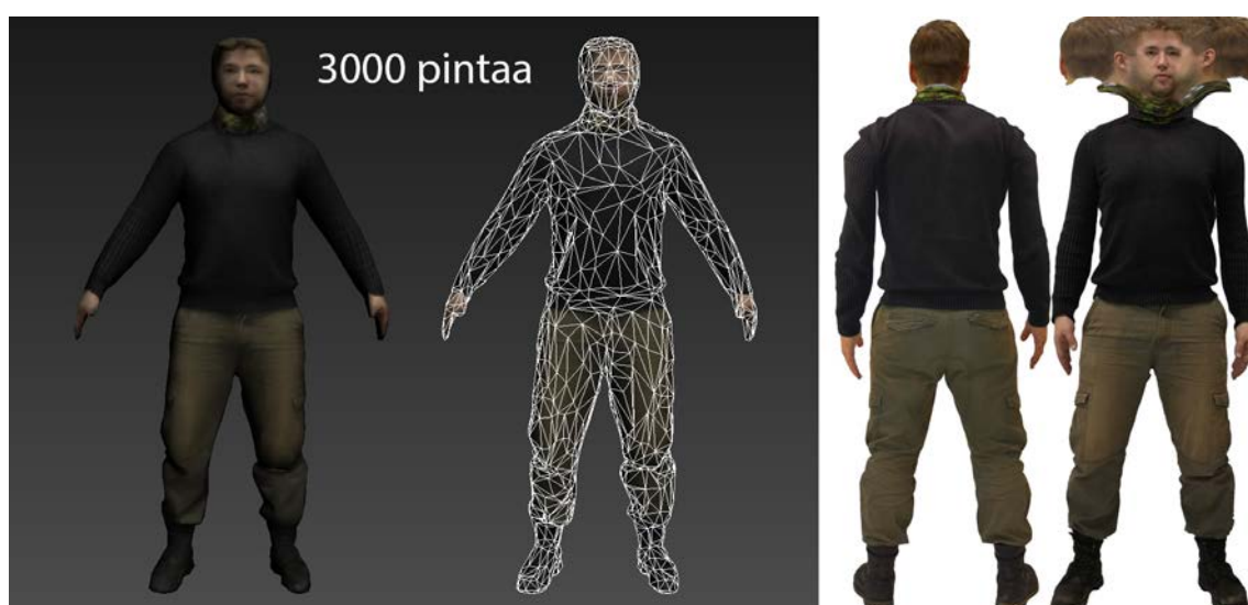
Kuva 20. 3D-skannatun 3D-mallin optimoinnin tulos ja kuvankäsittelyohjelmassa tehty tekstuuri.
