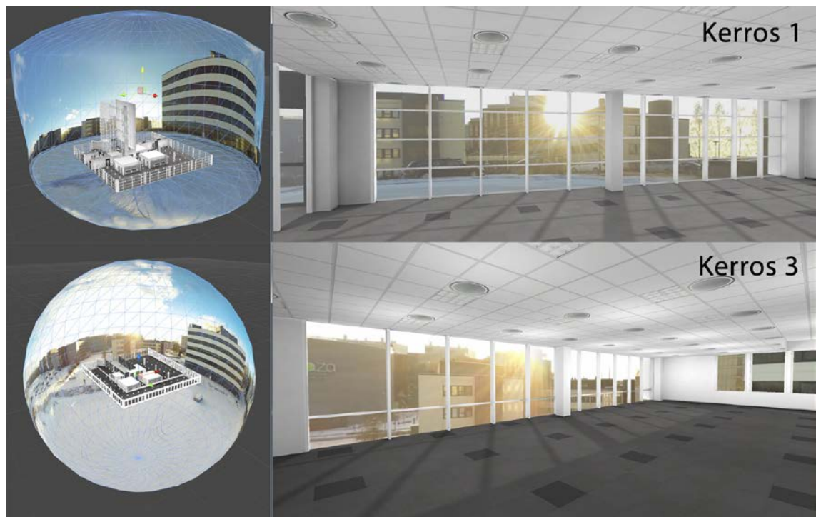
Kuva 30. Vasemmalla 360°-panoraamakuvat on asetettu pyöreisiin 3D-malleihin Unity3D -pelimoottorissa rakennuksen ympärille ja oikealla on näkymät rakennuksen sisältä, jossa 360°-panoraamakuvat esittävät taustalla ympäristöä.
