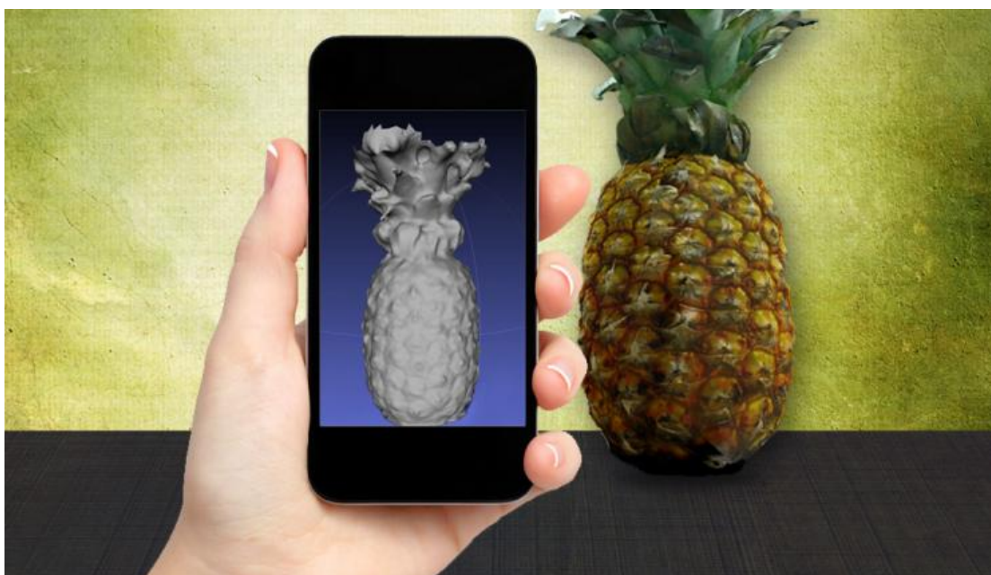
Kuva 31. 3D-skannausta mobiililaitteella (3-D scanning, with your smartphone 2014).
