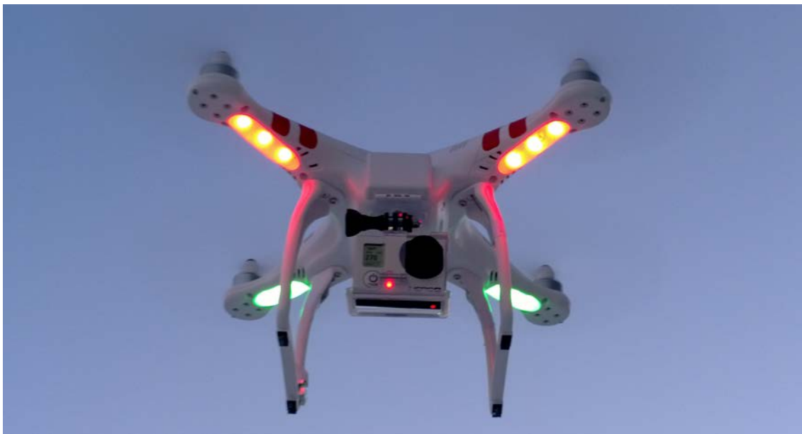
Kuva 27. Valokuva ilmassa lentävästä DJI Phantom 2 quadcopteristä, johon on kiinnitetty GoPro Hero 3 -kamera.
