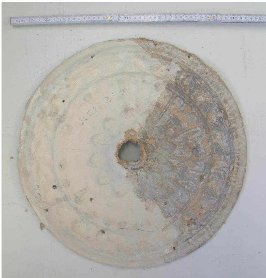
Kuva 61. Paksujen maalikerrosten alta löytyy yksityiskohtaista ornamentiikkaa.
