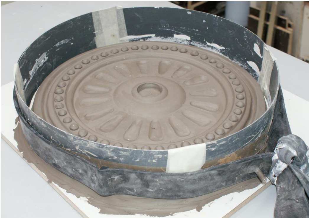
Kuva 44. Savimallin valmistelu muotin valamista varten.
