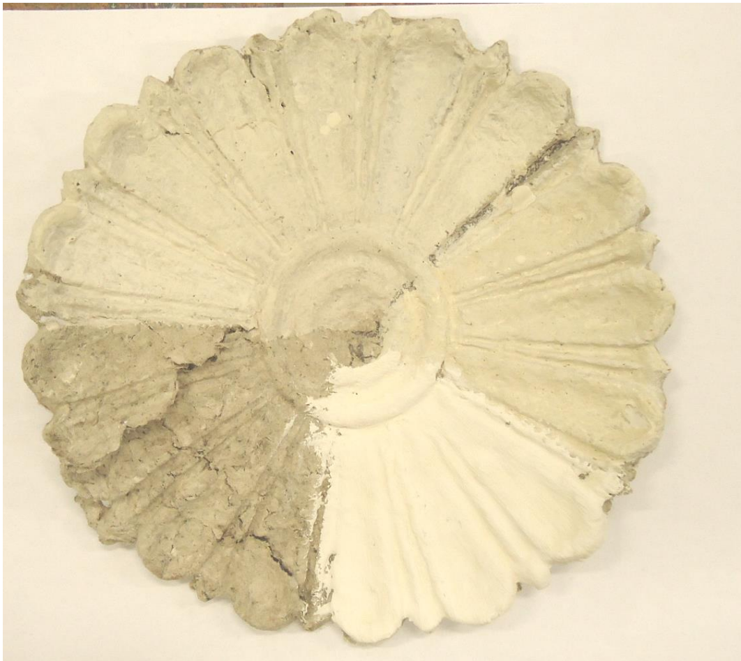
Kuva 53. Tummanharmaa alue pohjustamatonta paperimassaa, vaaleanharmaa alue liitupohjustus ja valkea alue kipsipohjustus.
