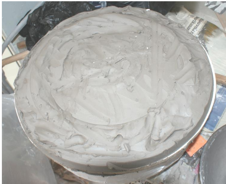
Kuva 37. Alussa savimalli dreijattiin kevyesti oikeaan muotoon.
