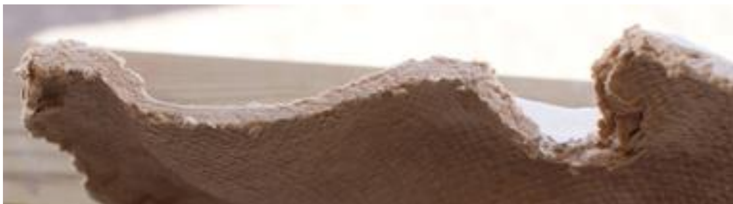
Kuva 21. Stanssaamalla valmistetun paperimassarosetin poikkileikkauskuva.
