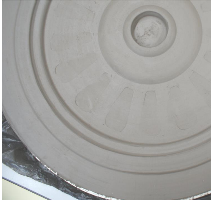
Kuva 40. Savimalliin painetut kuviot.
