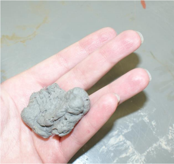
Kuvat 50. ja 51. Paperimassaa makuusalin rosettia varten ja valos kipsimuotissa.
