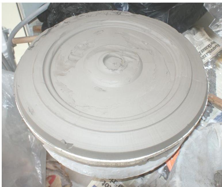
Kuva 38. Päämuodot dreijattuna savimalliin.
