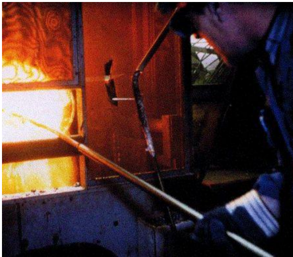
Kuva 10 Lämpötilan mittaus lanssin avulla (Van der Perre 2000)
