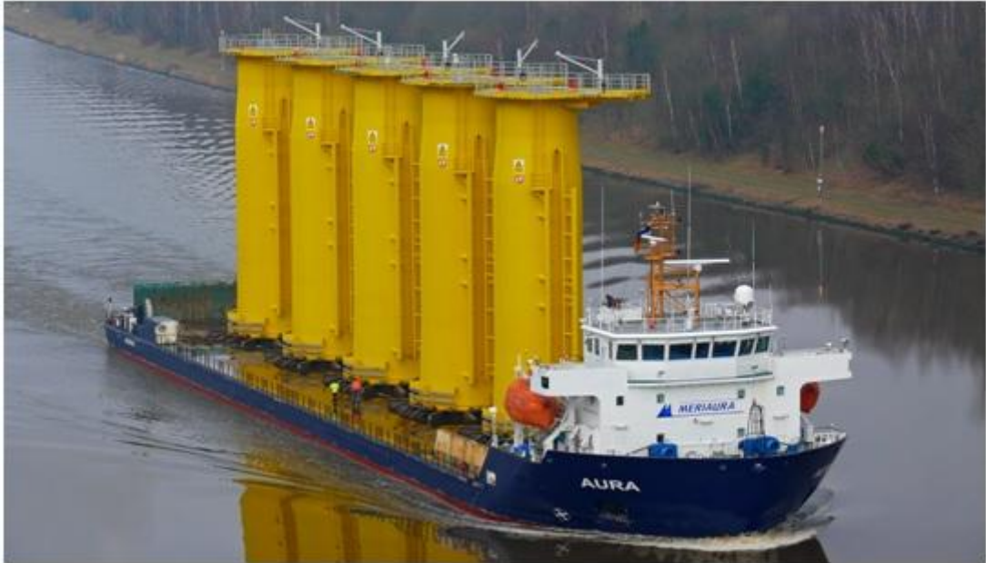
Kuva 2. M/S Aura kuljettamassa STX Finland Oy:n valmistamia merituulivoimaloiden tukijalkoja [33].
