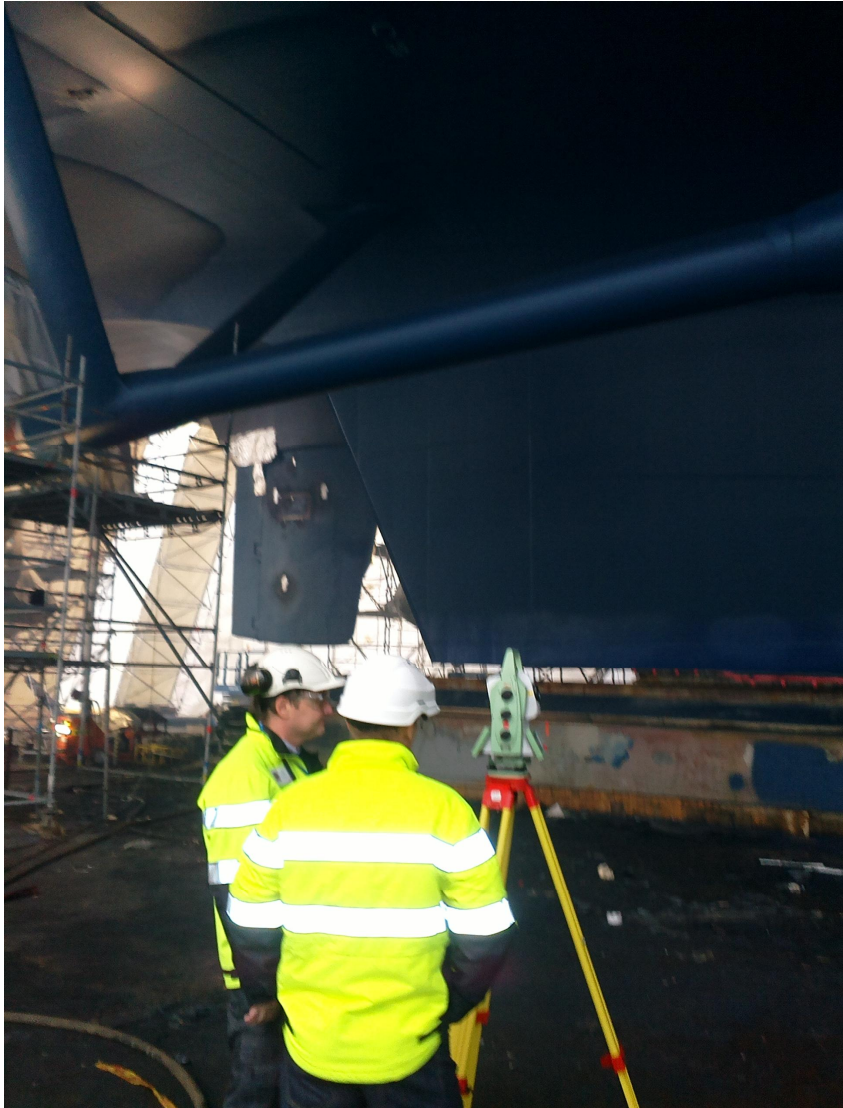
Kuva 13. Keilaus oli haastava pimeyden, kosteuden, keilauskohteen pinnan ja hyvien kojeasemien vähyyden takia.
