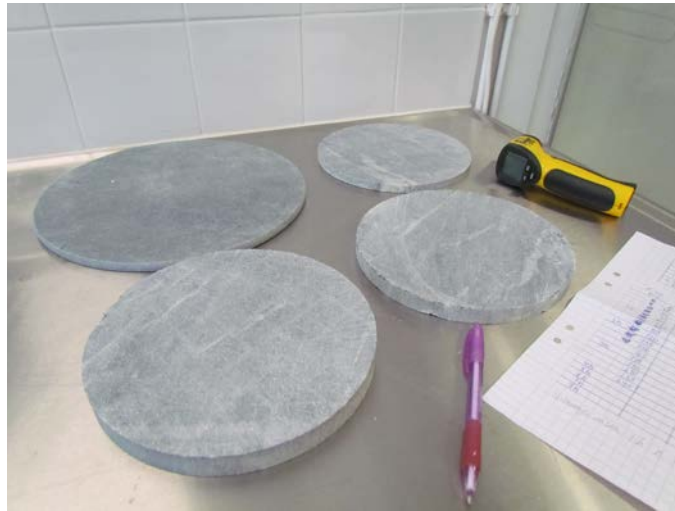
Kuva 8. Vuolukivikiekkojen lämpötilojen mittaus (Laamanen, 2014).
