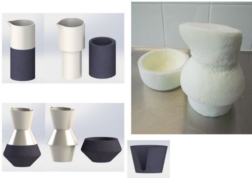
Kuva 10. Mallinnuksia ja styrofoam-hahmomalli maitokannusta (Laamanen, 2014).
